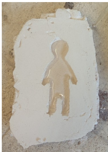
Obrázek 91 Sklo po utavení v sádrové formě.
