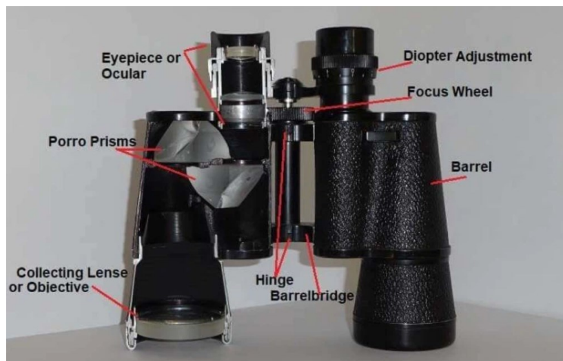
Obrázek 21 popis jednotlivých částí binokulárního dalekohledu 29
