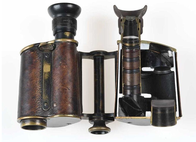
Obrázek 5 První dalekohled od společnosti Carl Zeiss využívající porro hranoly 9
