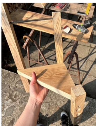
Obrázek 39 Zkouška velikosti odkládací plochy 1:1
