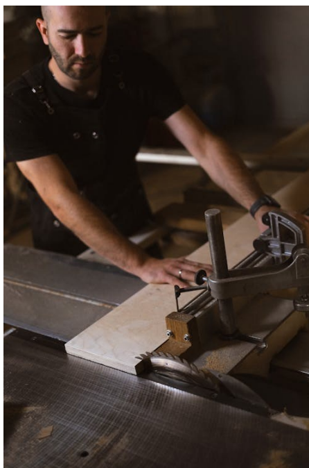
Obrázek 12 Řezání na kotoučové pile 47
