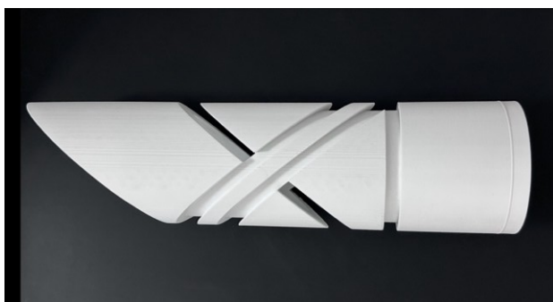
Obrázek 24 Povrchová struktura 3D tisku (vlastní foto)
