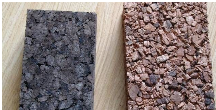
Obrázek 15 Expandovaný a bílý hrubý aglomerát korku 51
