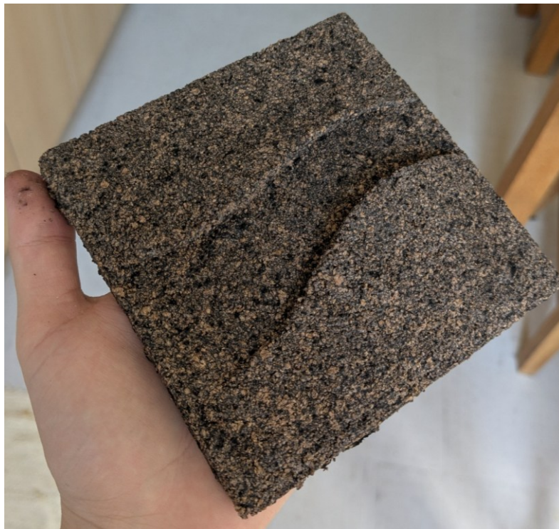
Obrázek 55 Obarvený akustický panel s aktivním uhlím
