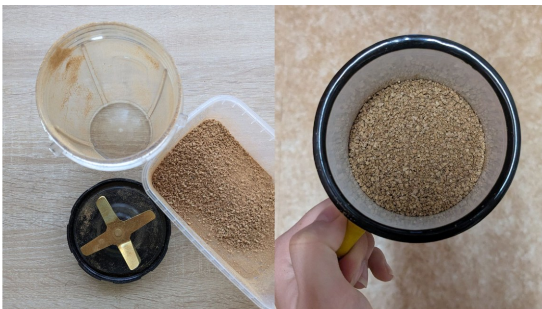
Obrázek 44 Zkoušky mletí korkových zátek
