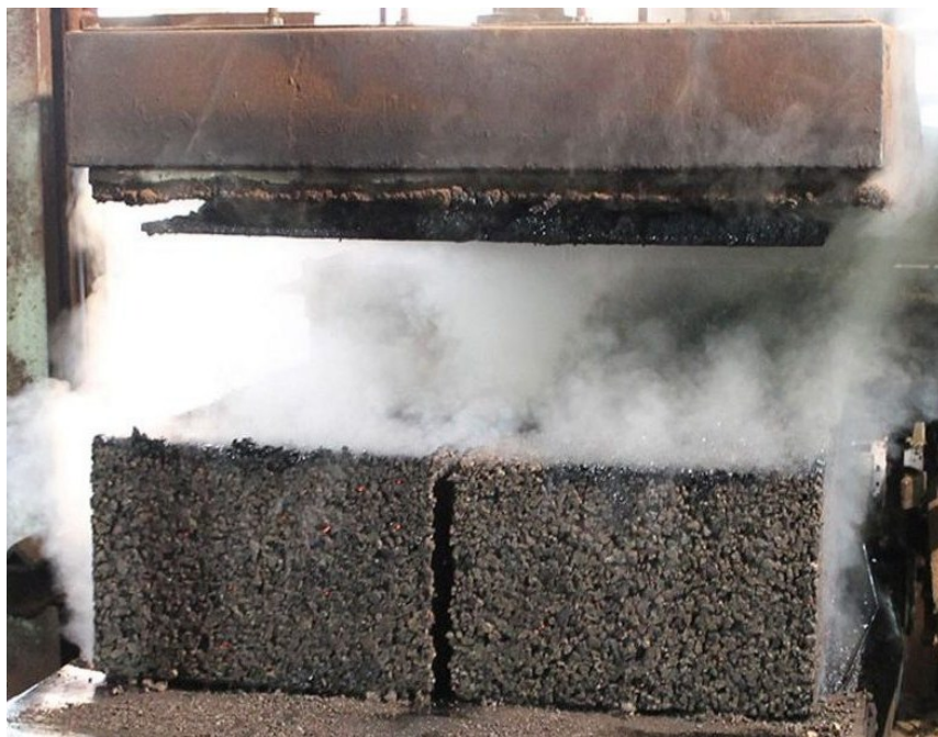
Obrázek 14 Expandovaný korek po výstupu z autoklávu 49
