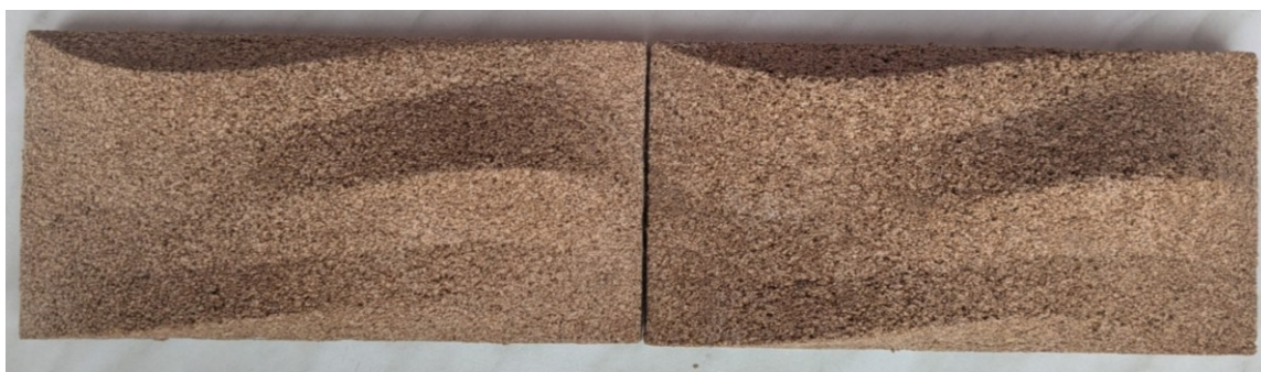
Obrázek 66 Vlevo poměr 1:1 a vpravo 3:2 (korek : latex)
