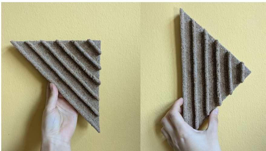
Obrázek 56 Prototyp akustického panelu „Geometrie vinic“
