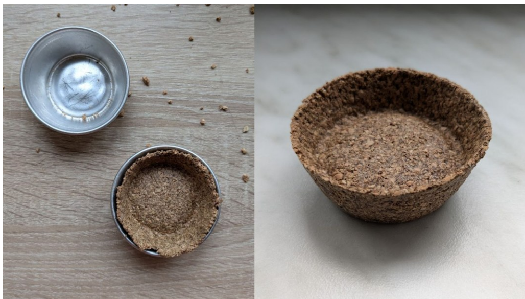
Obrázek 47 Test s tlakem ve formě na dezerty
