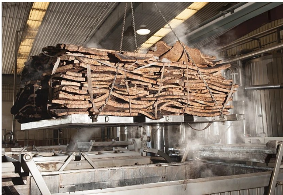
Obrázek 7 Vaření korkových plátů 26
