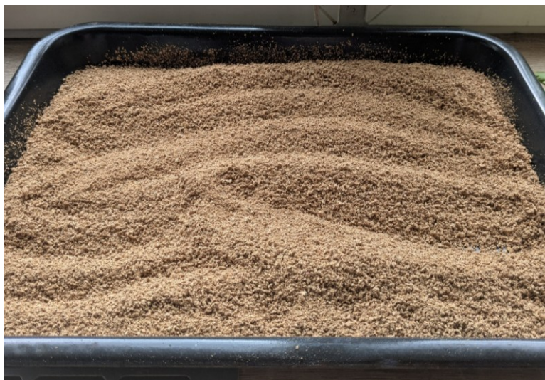
Obrázek 45 Sušení korkové drti
