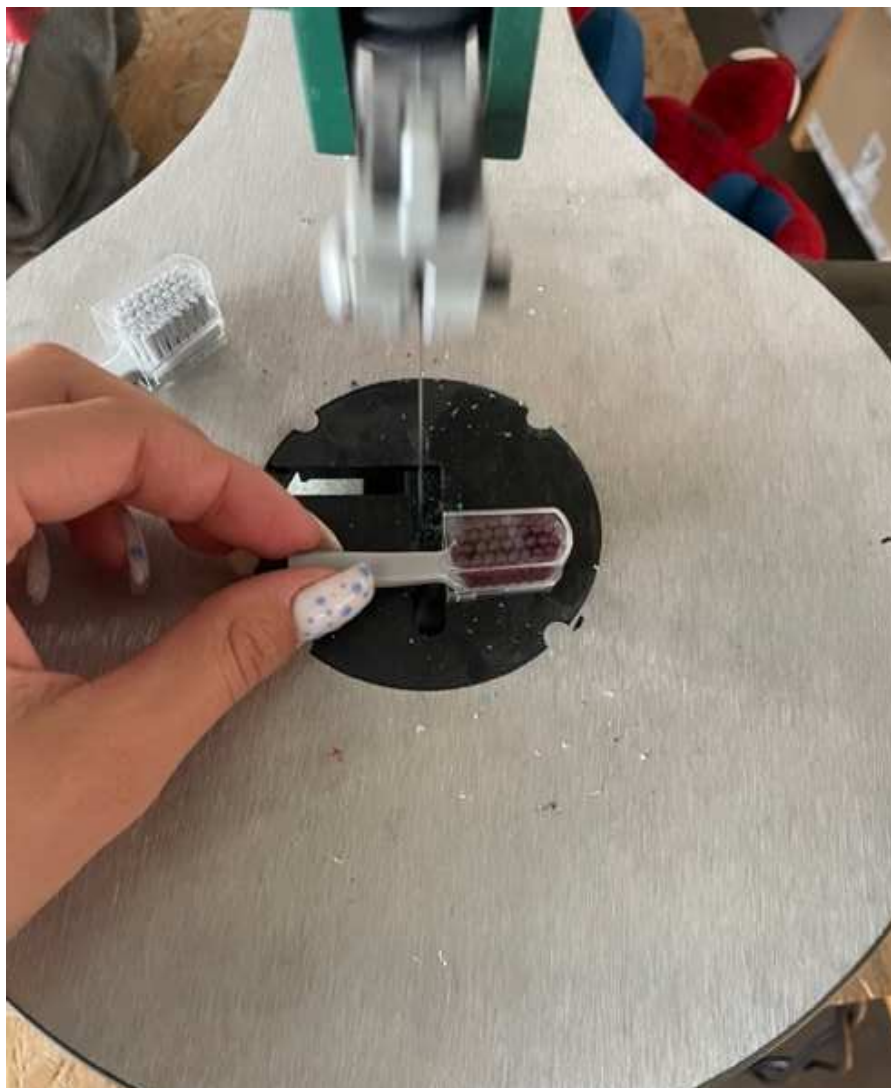
Obr. 38 Zrezanie prebytočného materiálu (vlastný zdroj)
