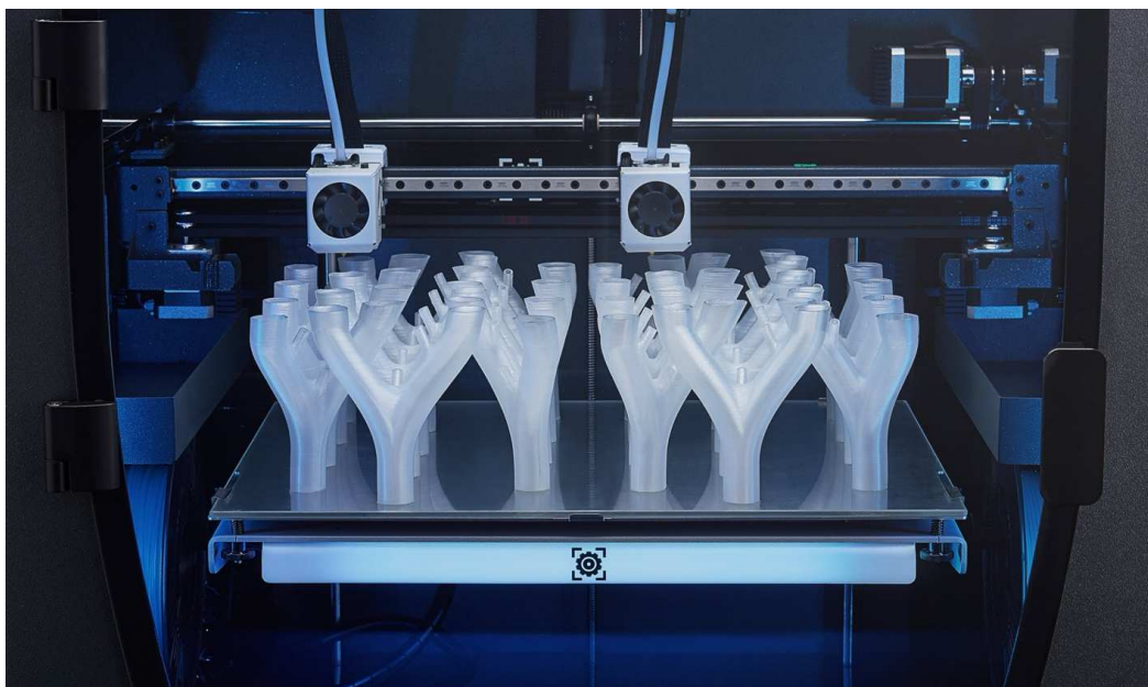
Obr. 17. Tlačenie viacerých modelov naraz 34
