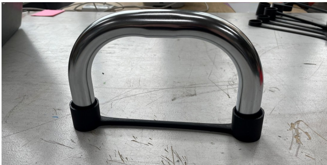
Obrázok 59. Skúška dosadenia kovového úchytu (zdroj:vlastný)
