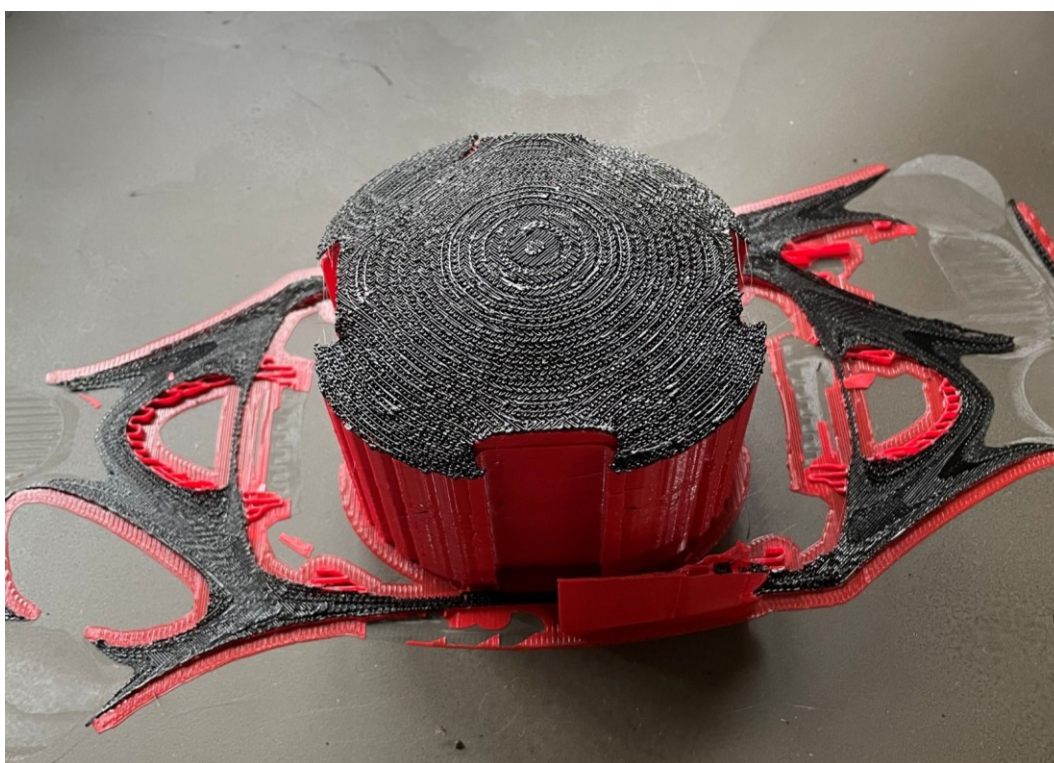
Obrázok 53. Zobrazenie supportov z PETG a PLA na Prusa XL (zdroj: vlastný)
