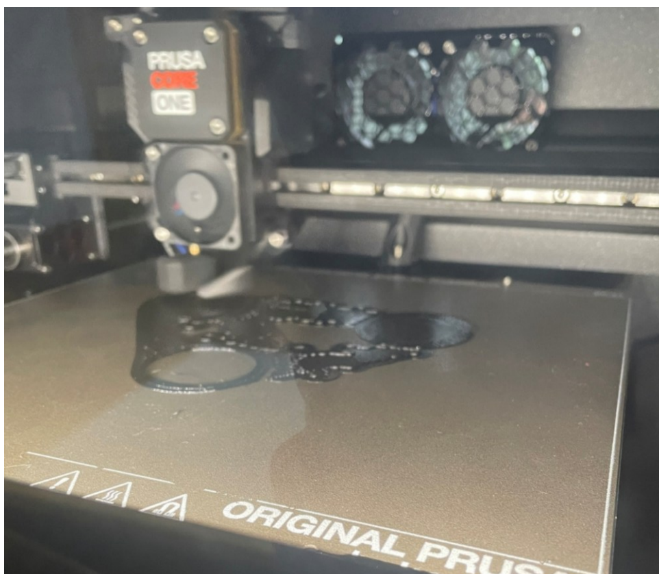
Obrázok 39. Tlač PET-G modelu (zdroj: vlastný)
