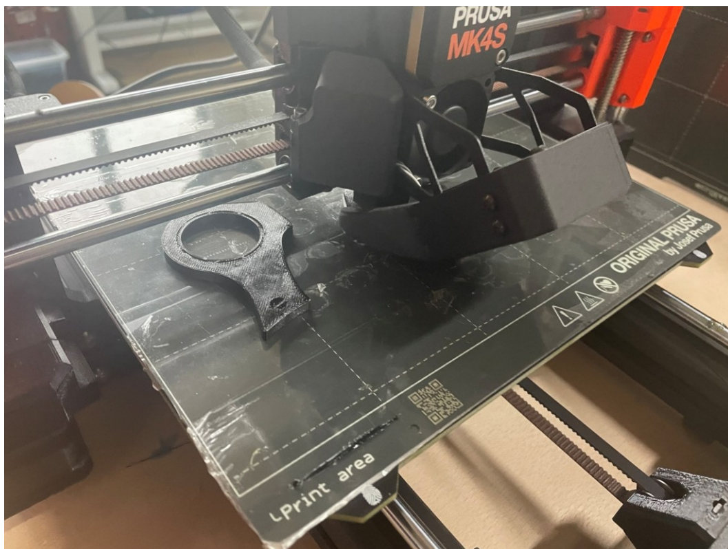
Obrázok 42. Skúška tlače z TPU (zdroj: vlastný)
