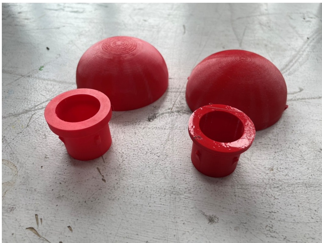
Obrázok 43. Tlač TPU modelov od značky Bambulab (vľavo) a Spektrum (pravo) (zdroj: vlastný)
