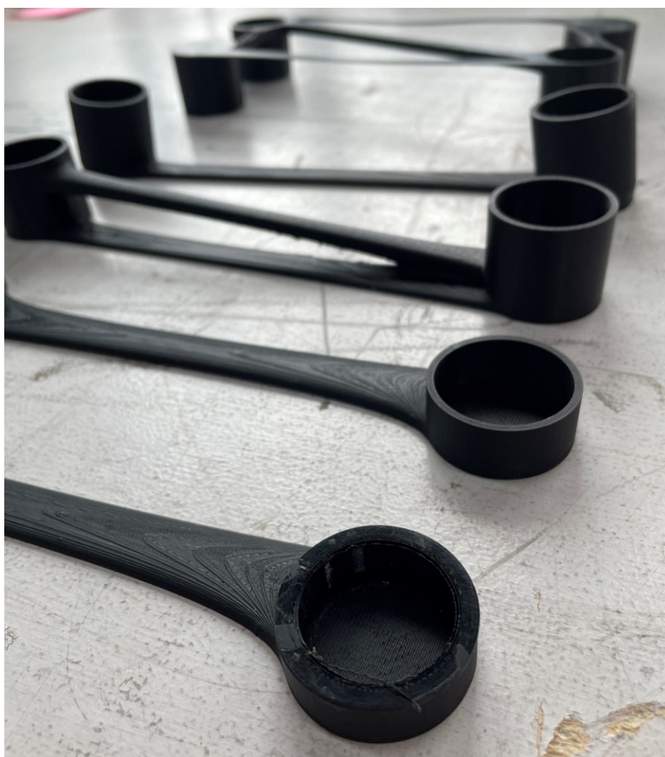
Obrázok 60. Veľkostné skúšky na kovový úchyt (zdroj: vlastný)
