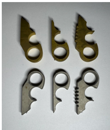
Obrázek 21: Řez 2 – zkouška řezu do oceli a mosazi
