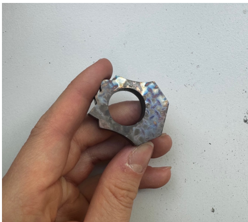
Obrázek 18: Výsledný povrch po zahřátí – druhá strana, která se dotýkala železné mřížky
