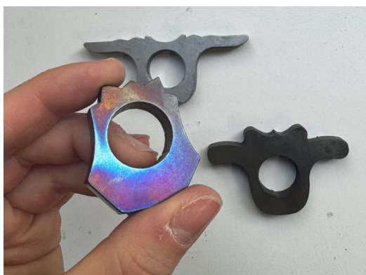
Obrázek 17: Výsledný povrch po zahřátí
