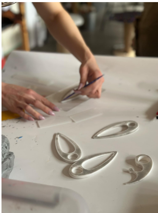
Obrázek 40: Workshop – vyrovnání povrchu modelu pomocí plastelíny
