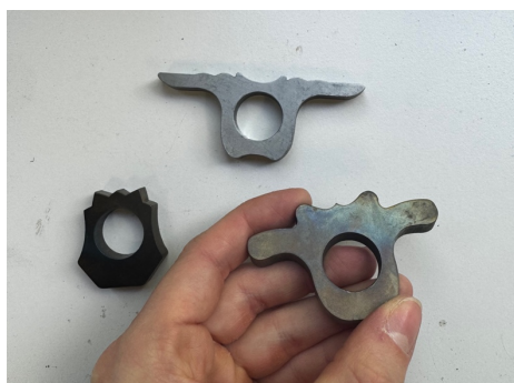
Obrázek 19: Výsledný povrch po zahřátí
