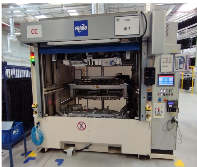
Obrázok 19 - Pracovná stanica ST6/ST7 – infračervené zváranie.
