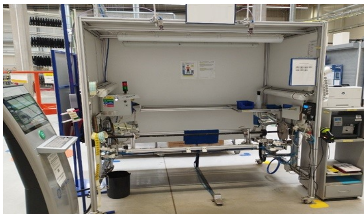
Obrázok 23 - Pracovná stanica ST10– výstupná kontrola.
