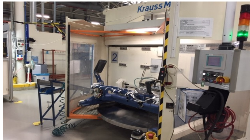
Obrázok 17 - Pracovná stanica ST5 – frézovanie.
