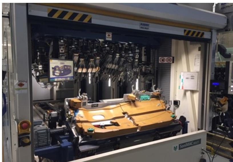
Obrázok 20 - Pracovná stanica ST8 – ultrazvukové zváranie.
