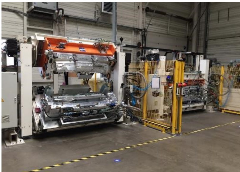
Obrázok 14 - Pracovná stanica ST2 – penenie.
