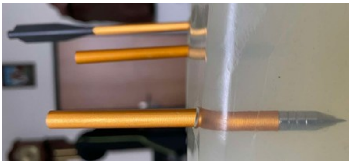
Obrázek 8. Zobrazení deformace na šípkách
