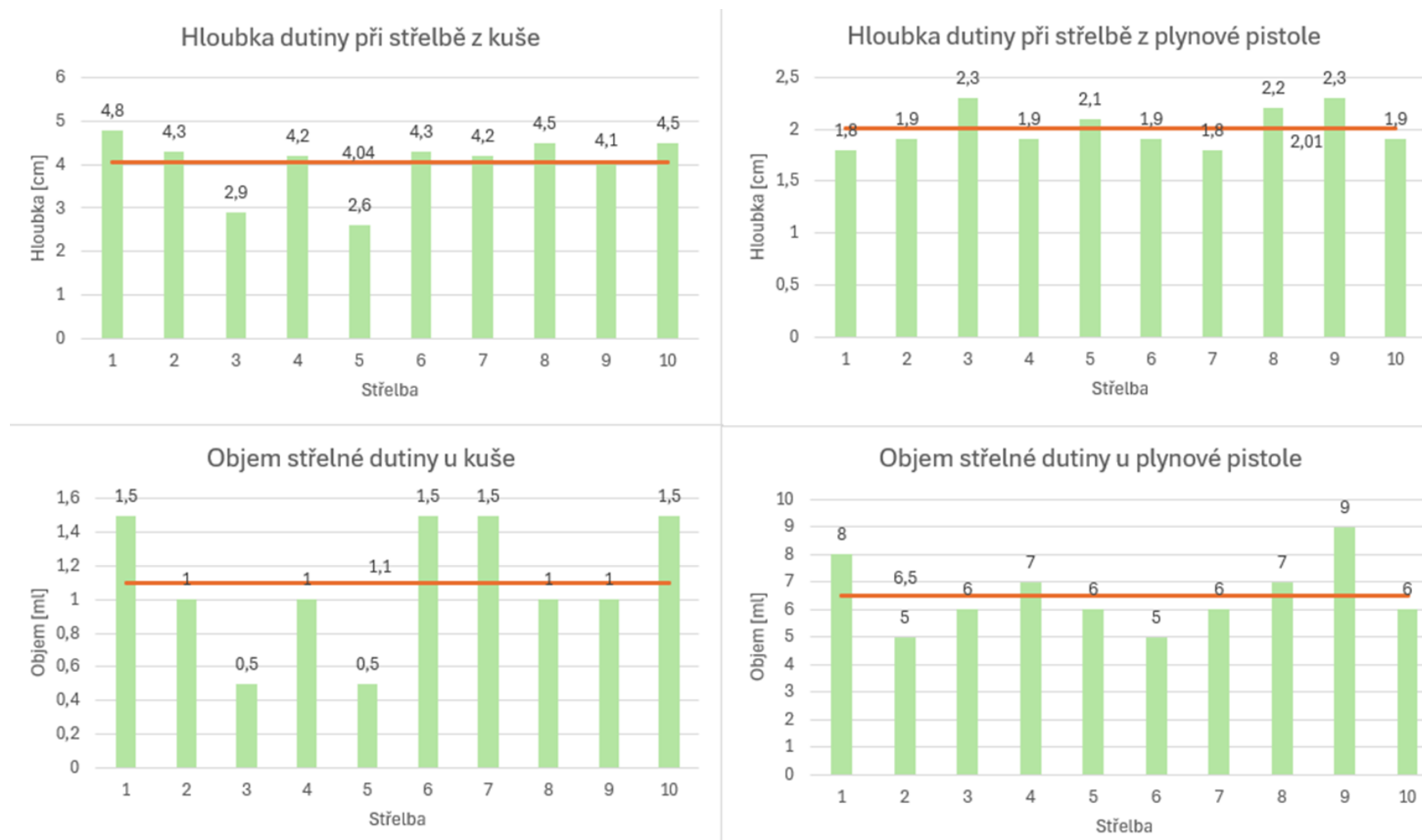
Obrázek 9. Grafické zobrazení hloubky a objemu střelných dutin u kuše a pistole
