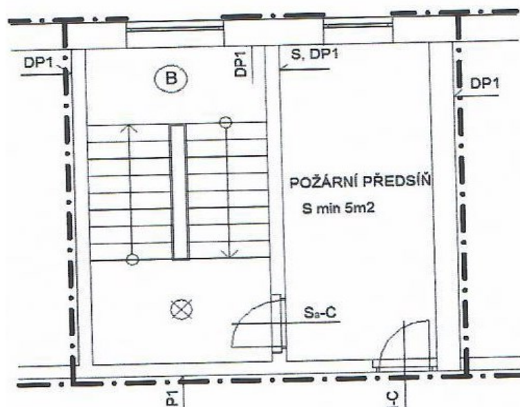
Obrázek 8 CHÚC typu B s požární předsíní
