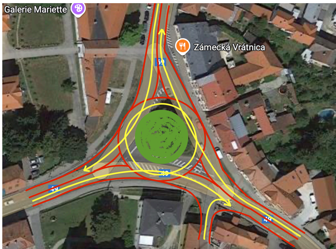
Obrázek 20 Návrh kruhové křižovatky
