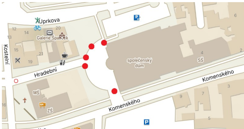
Obrázek 34 Rozmístění zábran proti vjezdu vozidla
