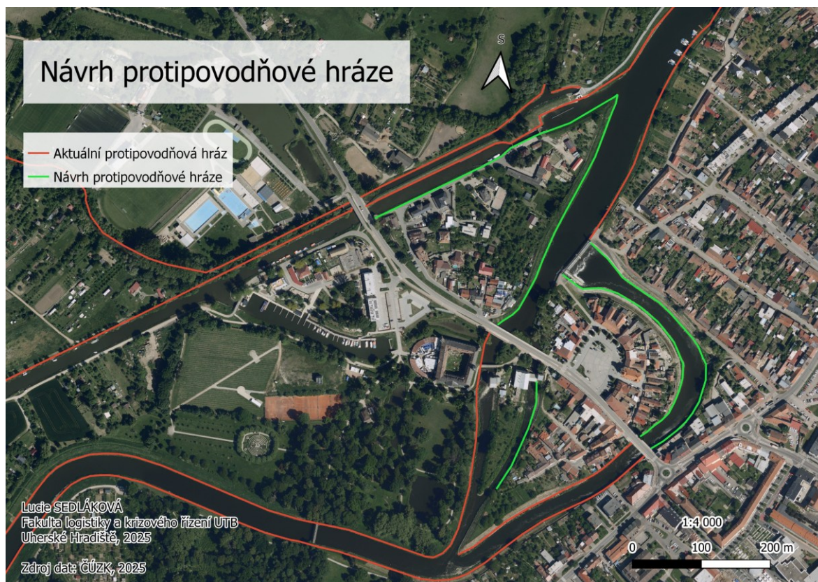
Obrázek 18 Návrh protipovodňové hráze
