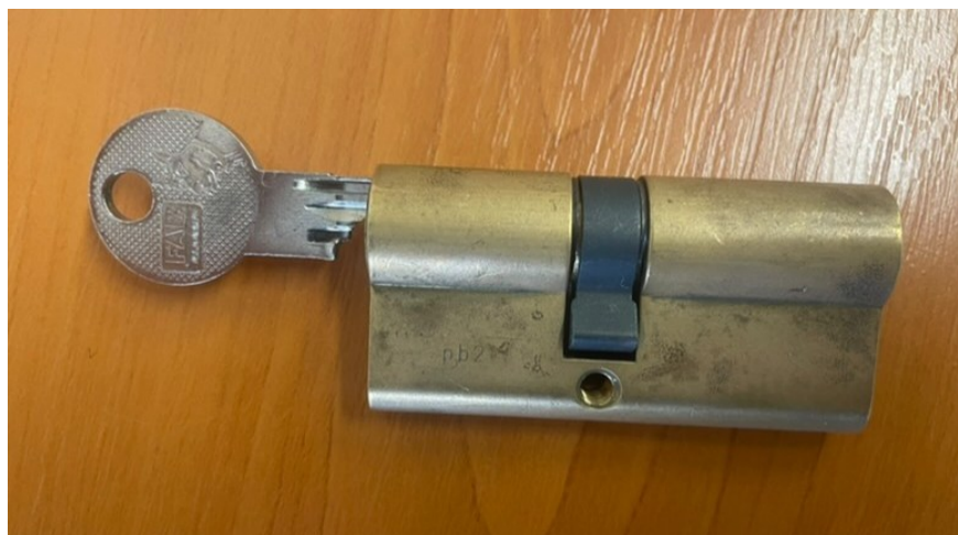
Obrázek 16 – cylindrická vložka s přípravkem na bumping
