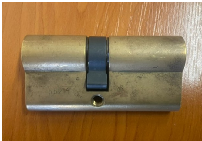
Obrázek 12 - Cylindrická vložka použitá v experimentu (boční pohled)
