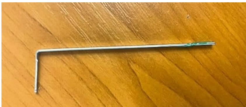
Obrázek 14 - Obrázek 15 – Napínák použitý v experimentu
