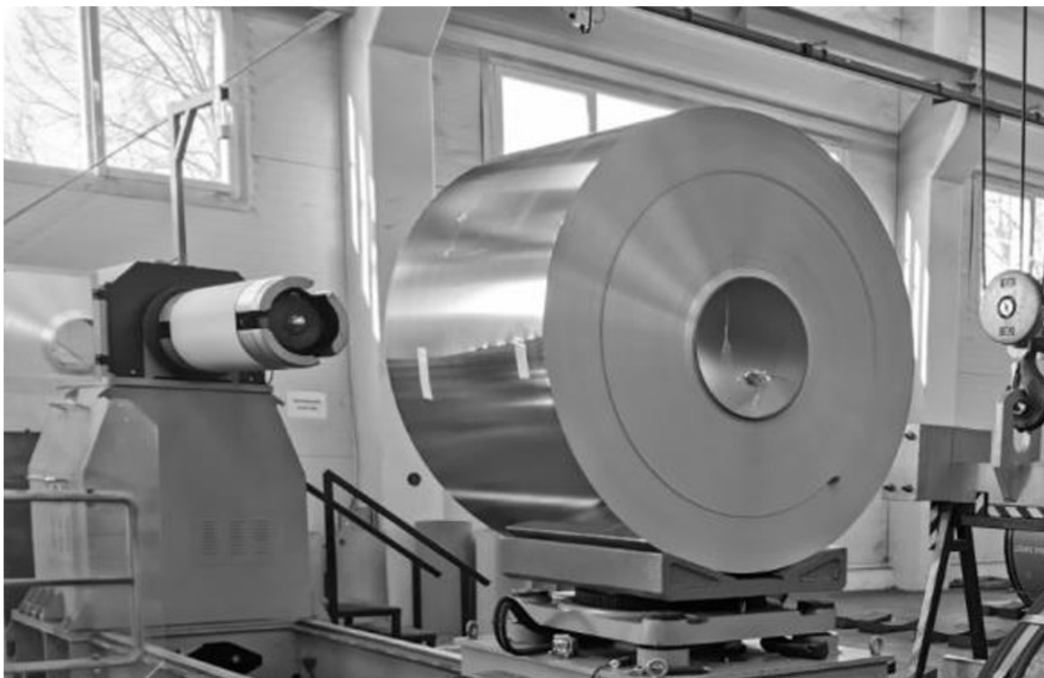
Obrázek 2 Cívka pro výrobu nádobky technologií DWI
