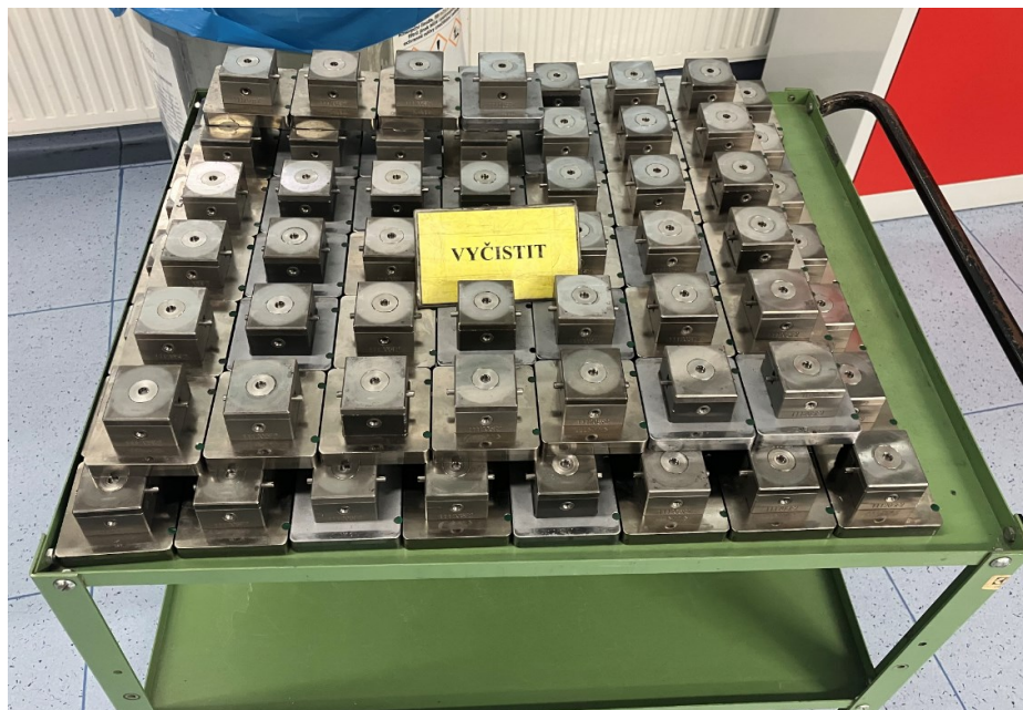
Obrázek 14 Vozík s nosiči obrobků v několika vrstvách (zdroj: vlastní)
