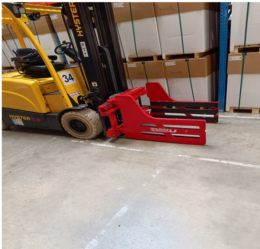
Obrázek 5 VZV se svěracími čelistmi užívaný v organizaci
