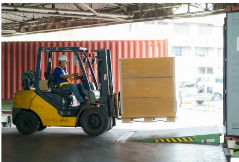
Obrázek 3 VZV najíždějící na vyrovnávací rampu
