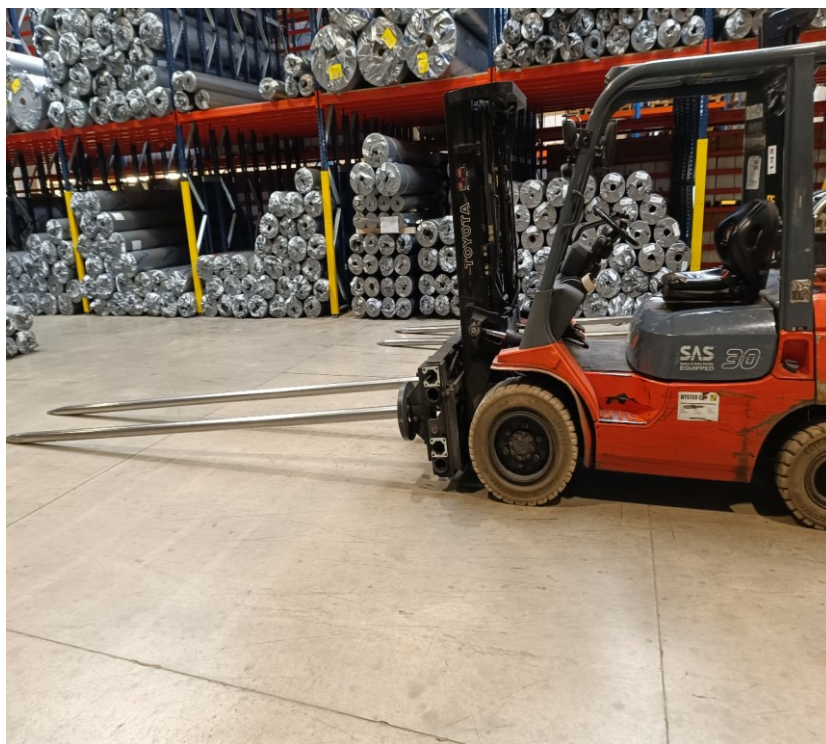
Obrázek 4 VZV s dvojitým nosným trnem užívaný v organizaci
