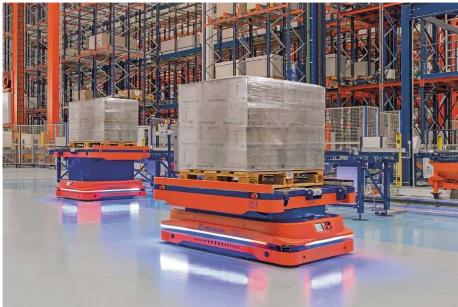
Obrázek 2 Paletový dopravník AMR 1500 od společnosti Mecalux přepravuje palety autonomně a bezpečně ve skladu.
