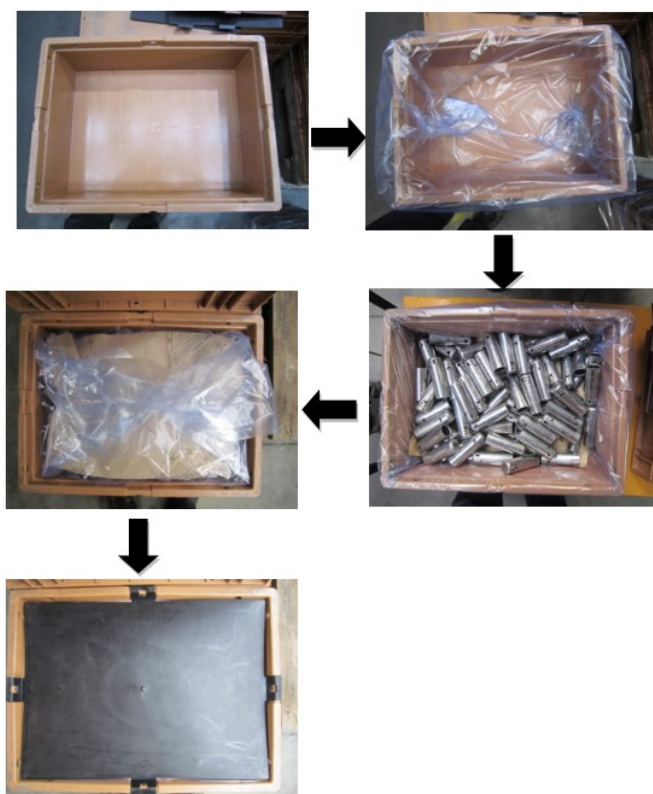
Obrázek 6 Postup balení do KLT boxů
