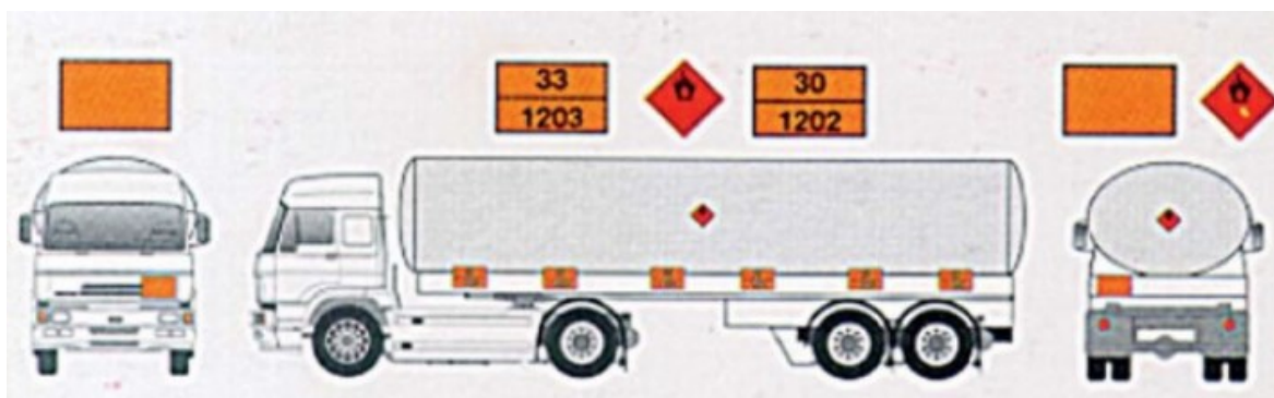
Obrázok 2 Označenie dopravnej jednotky prepravujúcej nebezpečné veci (Zdroj: Požární ochrana, rok neuvedený)
