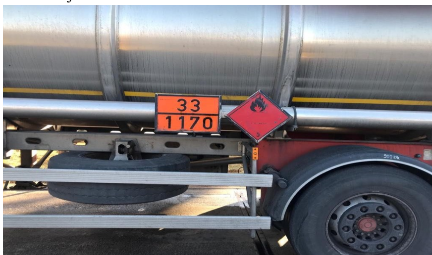
Obrázok 6 Označenie cisterny pri preprave rafinovaného liehu
