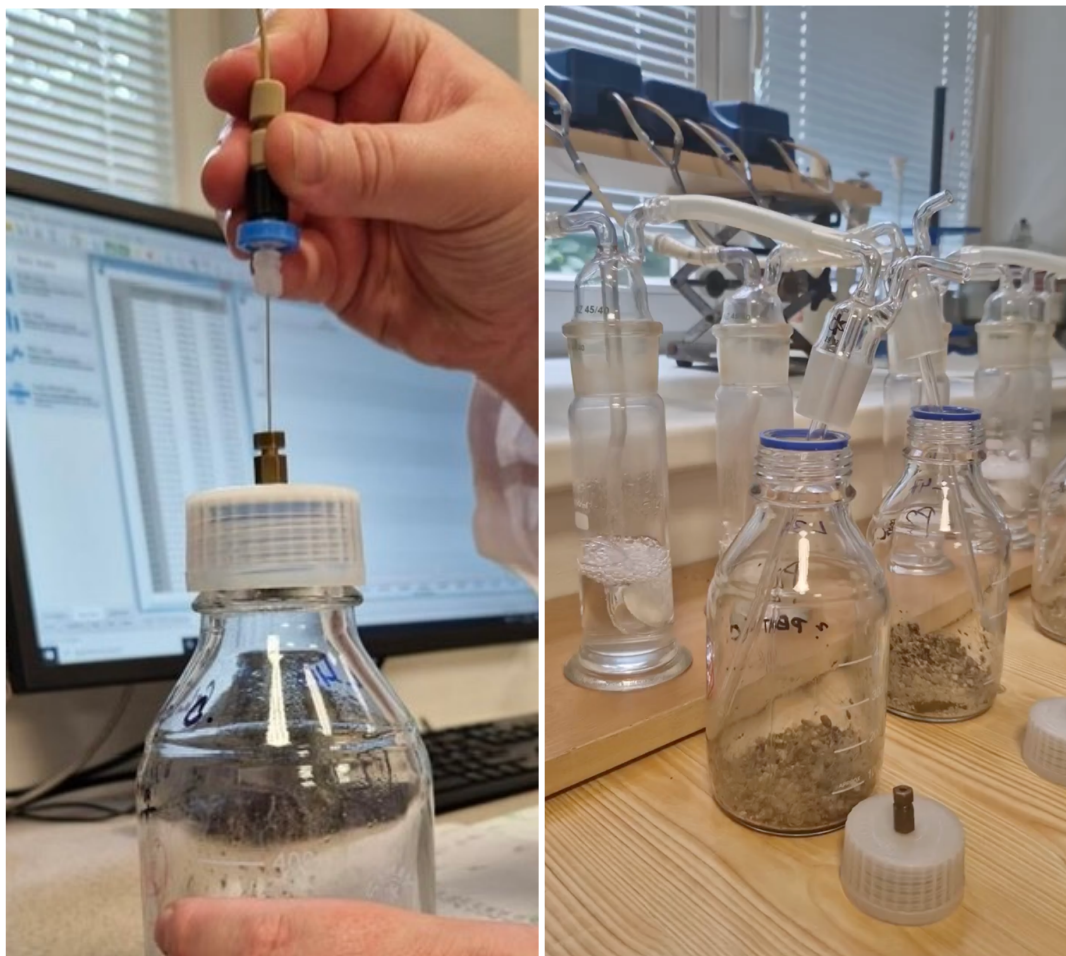
Obrázek 12 Měření mineralizace – propíchnutí septa plynotěsného uzávěru kapilární jehlou (vlevo), provzdušňování lahví po analýze (vpravo)
