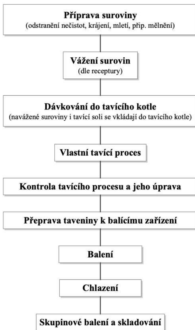
Obrázek 2: Schéma výroby tavených výrobků [upravené podle 46]
