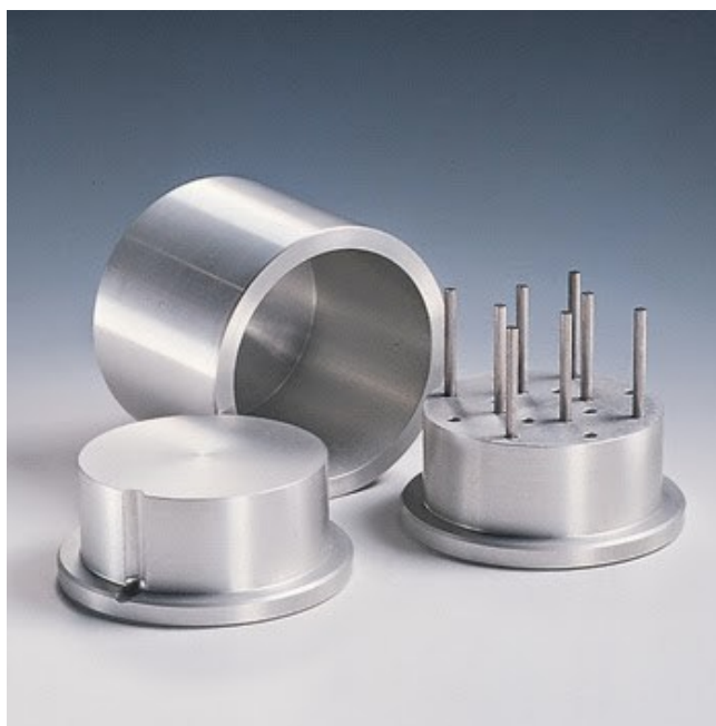
Obrázek 4 – Nástavec Dough separation set (TextureAnalysisProfessionals, 2014)
