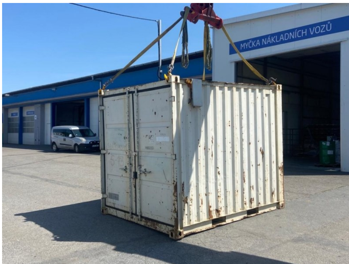
Obrázek 1 Rohové prvky kontejneru
