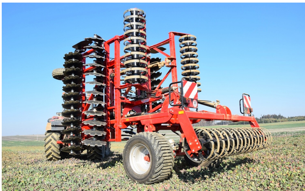
Obrázek 4 Diskový podmítač SUPERIOR od firmy SMS – Složená konstrukce rámu
