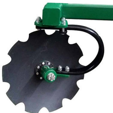
Obrázek 8 Spojení slupice s rámem
