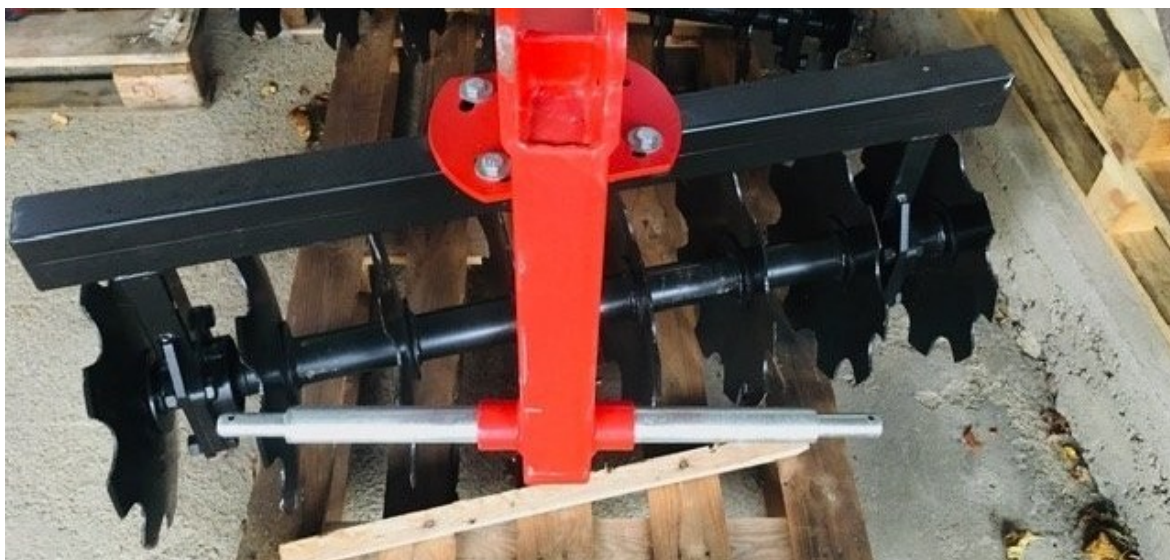
Obrázek 6 Ukázka spojených otočných disků
