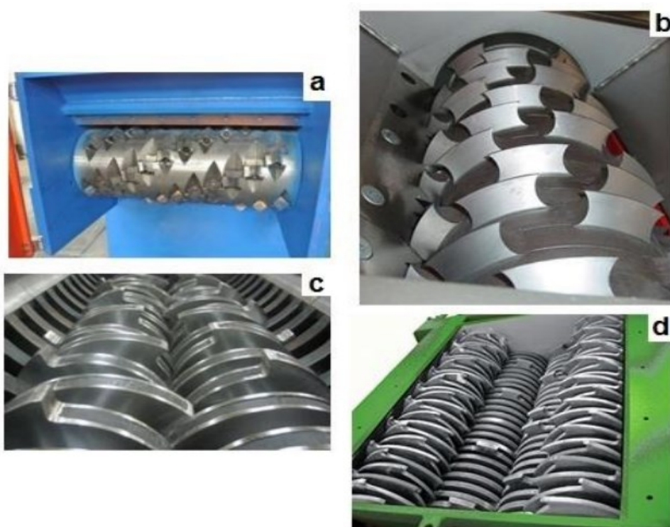
Obr. 8 Různé typy hřídelových drtičů:
