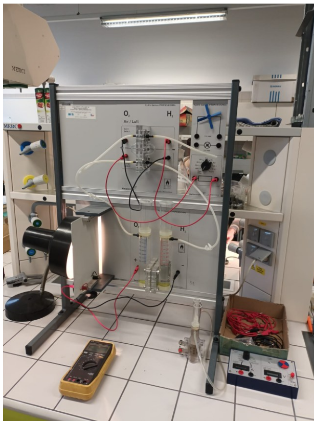
Obrázek 29 Fotografie zapojení měřící aparatury pro měření voltampérové charakteristiky dvou palivových článků řazených Sériově
