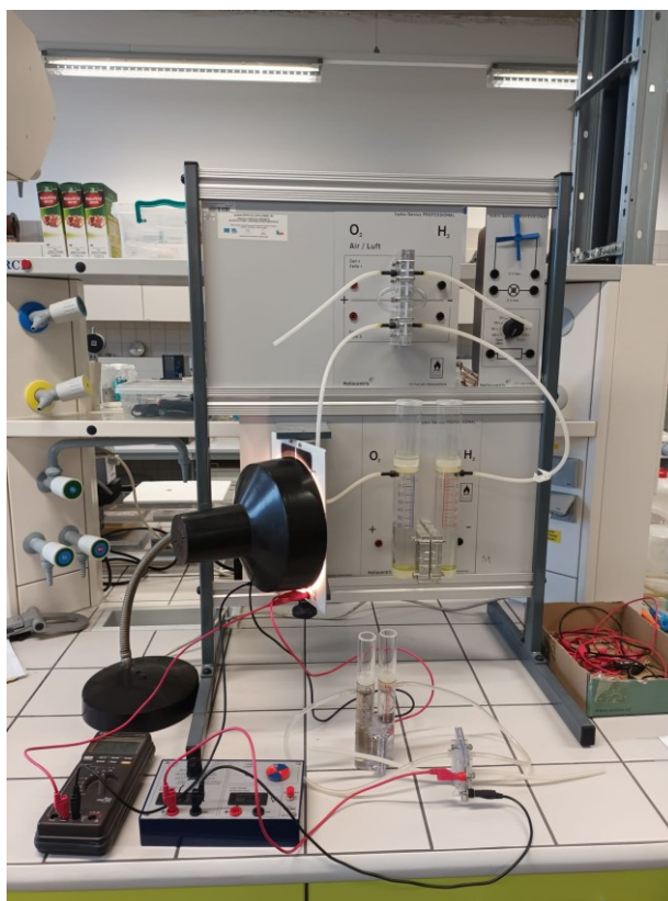
Obrázek 24 Fotografie zapojení měřicí aparatury pro účinnosti sestavy elektrolyzéru a palivového článku
