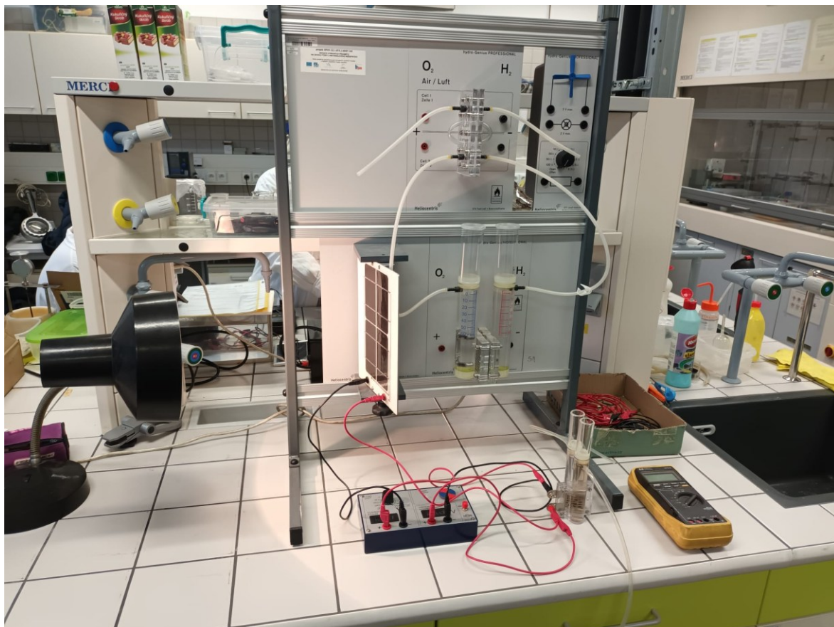
Obrázek 21 Fotografie zapojení měřící aparatury pro měření voltampérové charakteristiky elektrolyzéru
