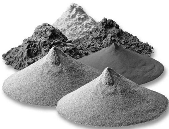
Obrázek 7 Různé druhy kovových prášků pro aditivní výrobní technologie [11]
