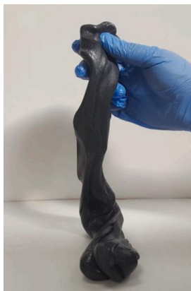
Obrázek 31 AFM medium MV50 [46]
