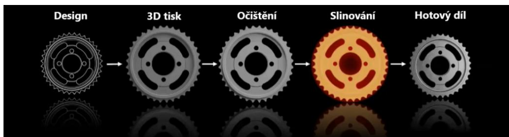
Obrázek 25 Jednotlivé kroky procesu ADAM [33]
