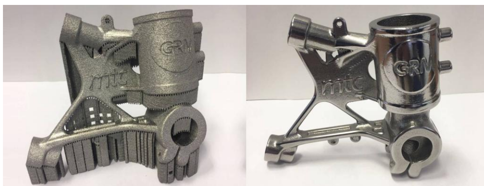
Obrázek 27 Srovnání aditivně vyrobené součásti před a po dokončování [38]
