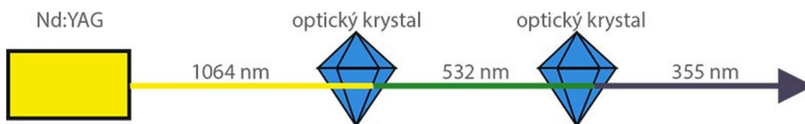
Obrázek 21 Přeměna záření Nd:YAG laseru na 532 nm a 355 nm
