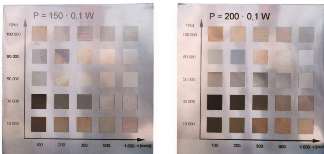
Obrázek 38 Porovnání vzhledu značení na oceli 1.4401 při výkonech 15 W a 20 W
