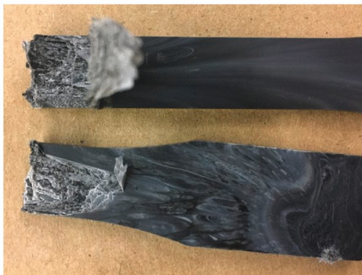
Obrázek 6 Příklad delaminace dvou nekompatibilních materiálů
