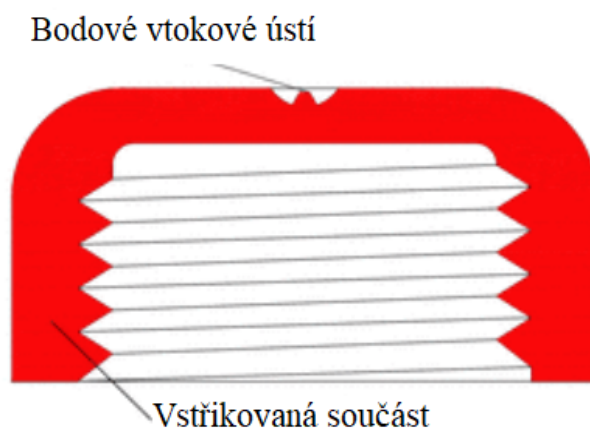
Obrázek 20 Princip středěného bodového vtokového ústí
