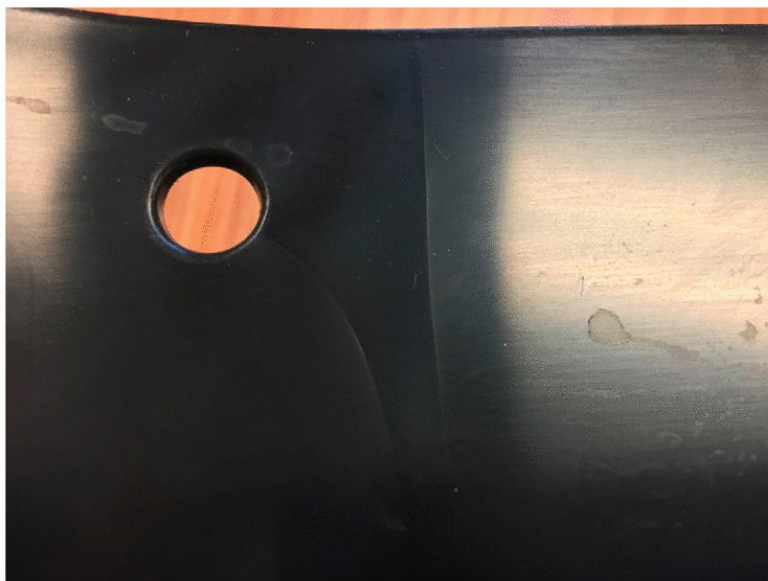
Obrázek 16 Příklad studeného spoje
