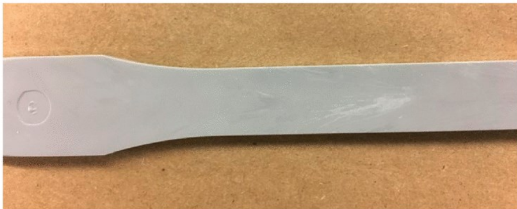
Obrázek 13 Příklad stříbrných pruhů
