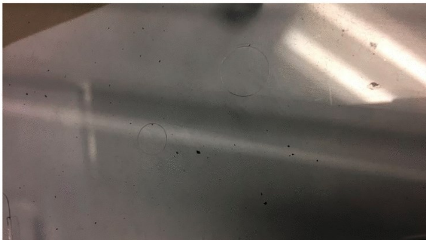
Obrázek 12 Příklad černých teček na výrobku
