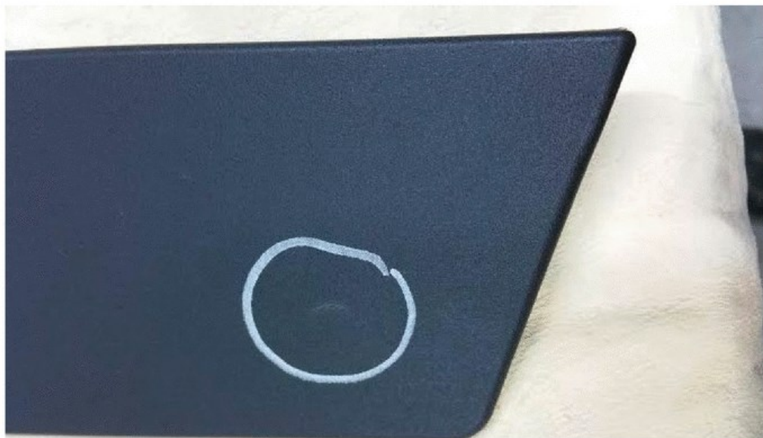
Obrázek 7 Příklad stopy po vyhazovači
