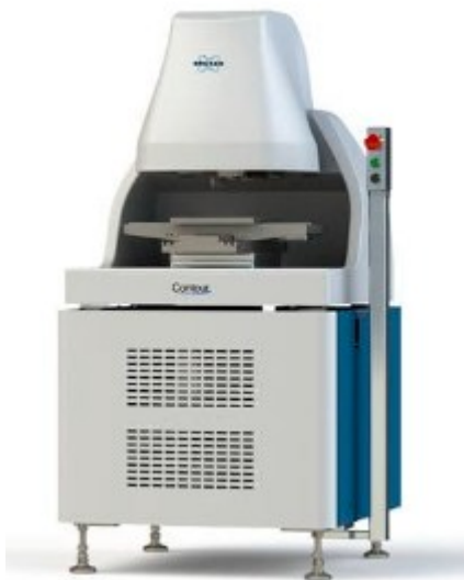
Obrázek 31 Optický profilometr Bruker Countour
