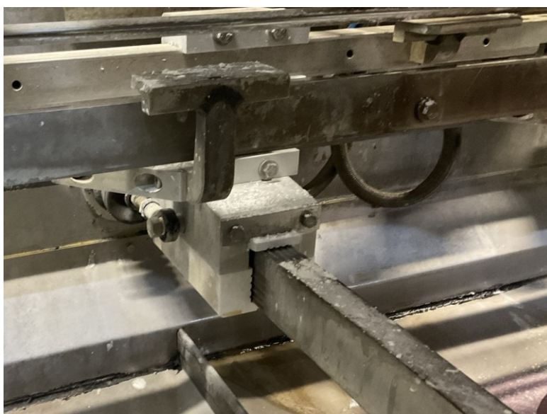
Obrázek 81 Způsob upnutí příčného kluzného vedení
