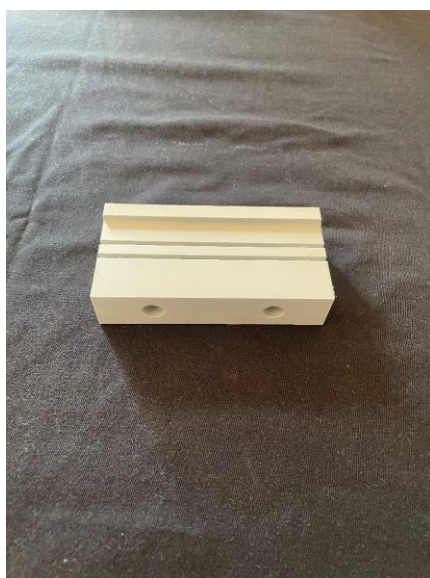
Obrázek 54 Hotová součást podélného kluzného vedení tvaru L
