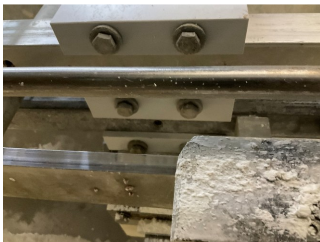
Obrázek 80 Způsob upnutí podélného kluzného vedení
