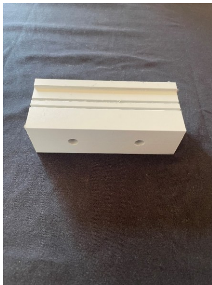
Obrázek 61 Hotová součást podélného kluzného vedení tvaru T
