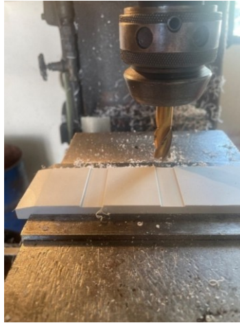
Obrázek 66 Frézování příčných drážek
