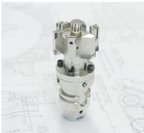
Obrázek 12 Fréza z polykrystalického diamantu
