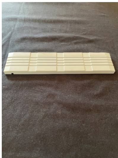
Obrázek 69 Hotová součást příčného kluzného vedení
