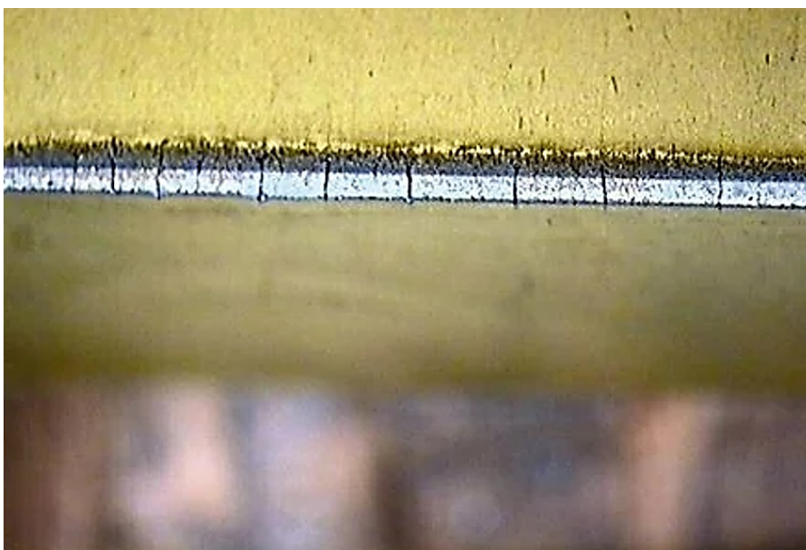
Obrázek 13 Příklad tepelné hřebenové trhliny
