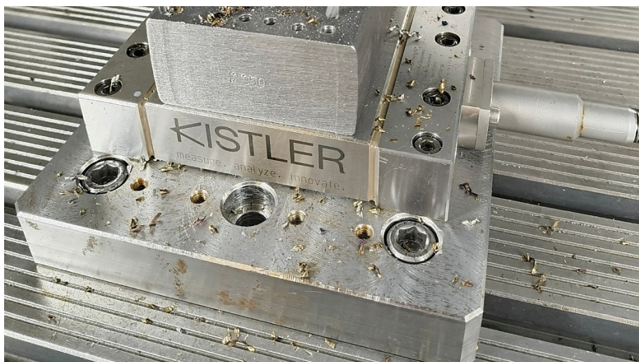
Obrázek 19 Dynamometrické zařízení Kistler
