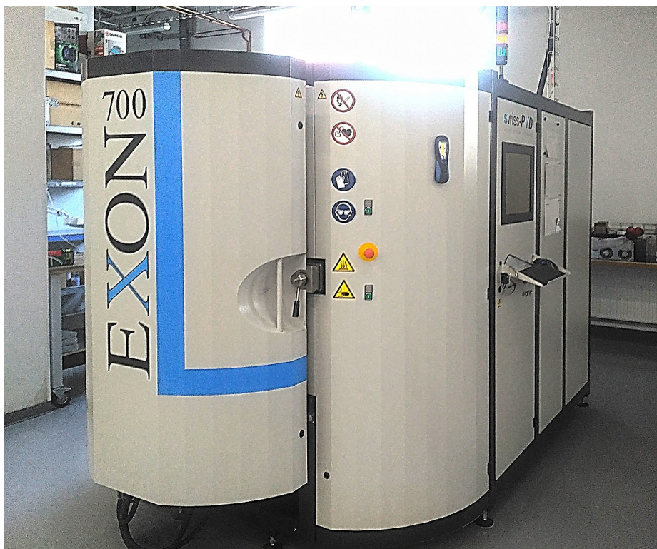
Obrázek 9 Pec na povlakování nástrojů
