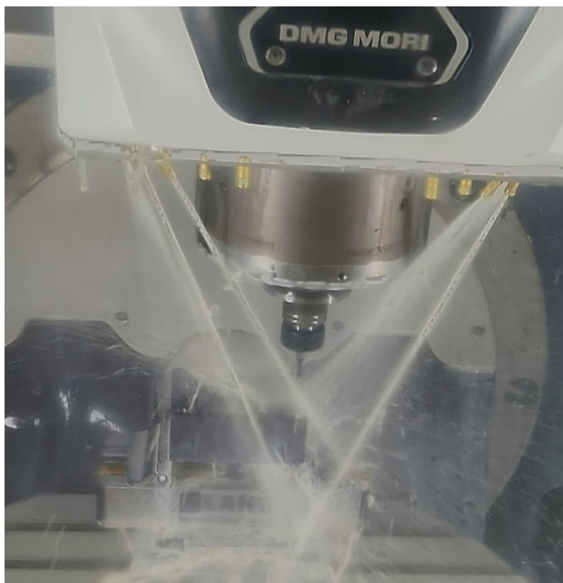
Obrázek 17 Vrtání děr do polotovaru s chladicí emulzí
