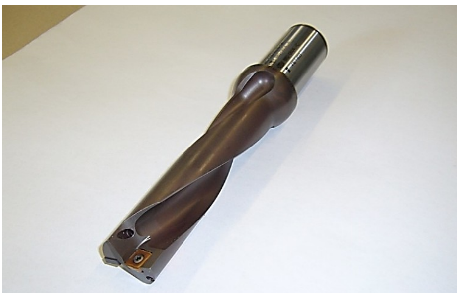
Obrázek 4 Vrták s výměnnou břitovou destičkou
