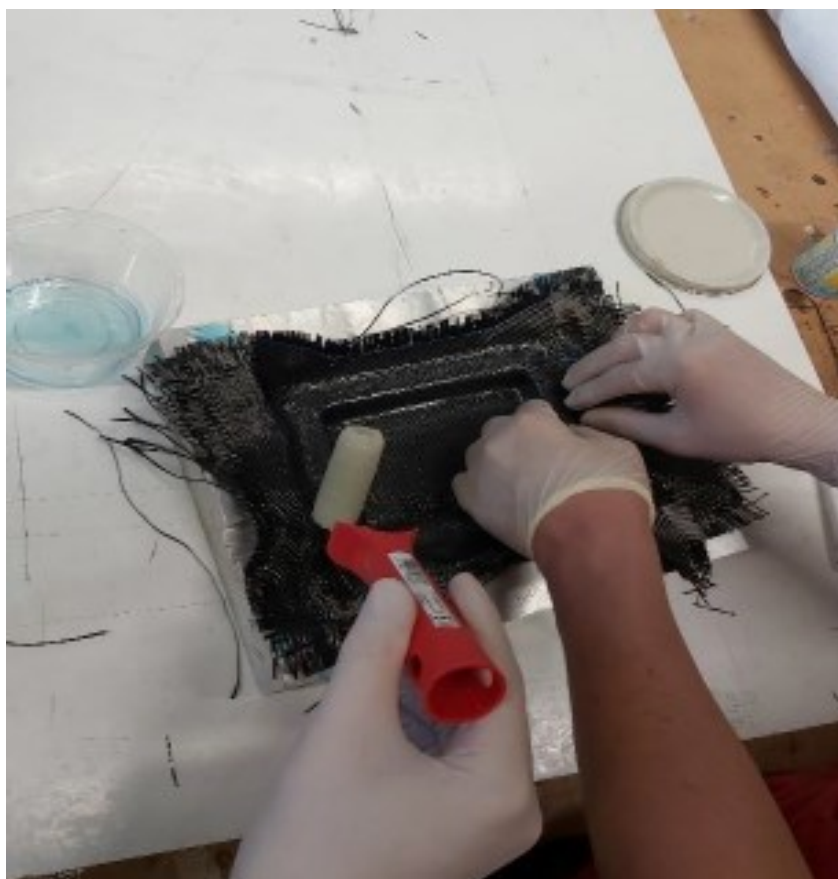
Obrázek 7 – Tvarování jednotlivých vrstev tkaniny a jejich prosycování pryskyřicí pomocí válečku
