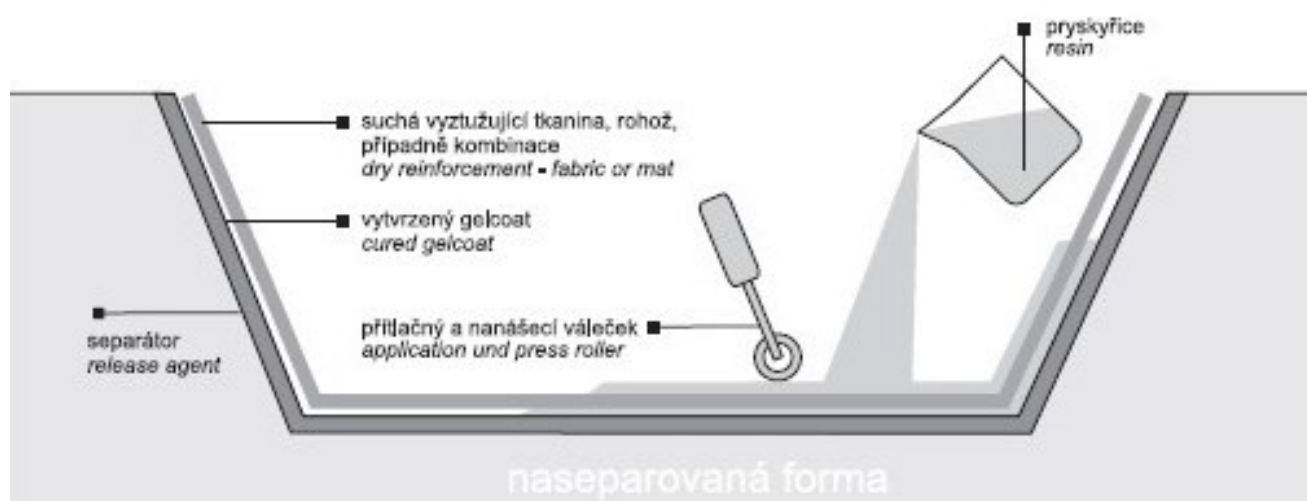
Obrázek 6 – Princip ruční laminace [10]
