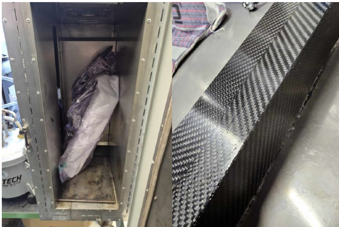
Obrázek 11 – Vložení formy do předehřáté pece a detailní pohled na pohledovou stranu finálního výrobku
