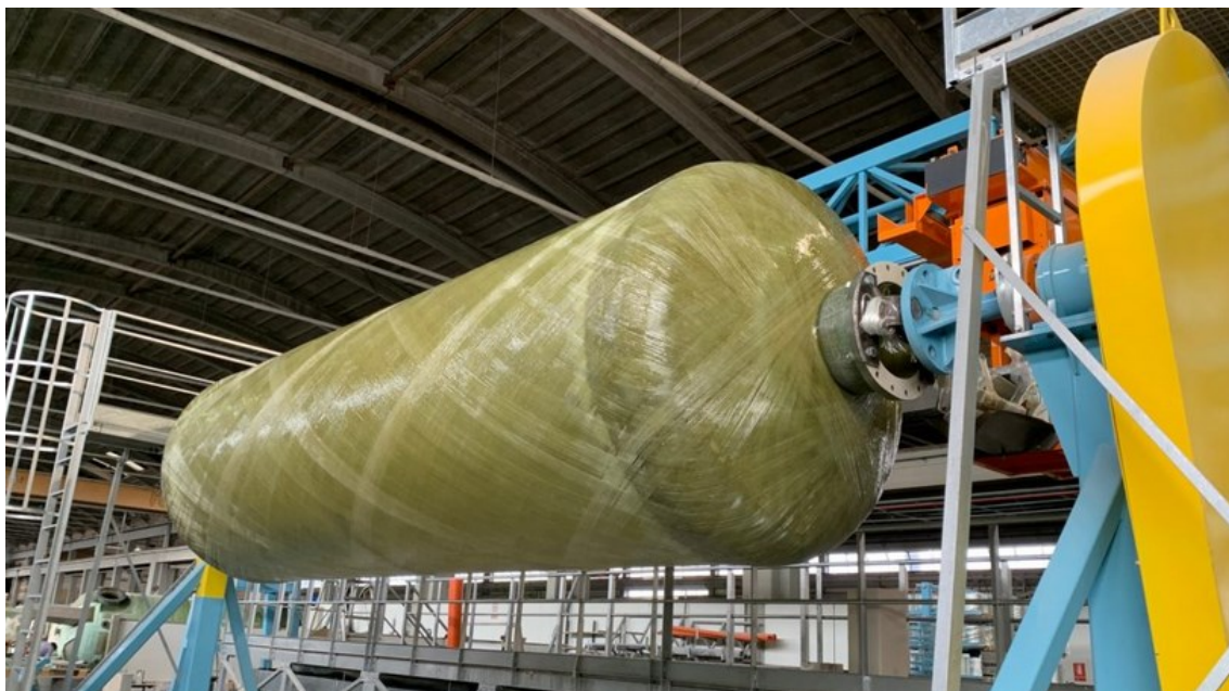
Obrázek 15 – Tlaková nádrž vyrobená technologií vinutí vláken [16]
