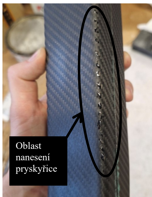
Obrázek 44 – Nanesená pryskyřice na vzorku č.2
