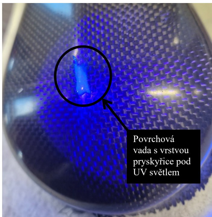
Obrázek 48 – Vytvrzování pryskyřice pomocí UV lampy na vzorku č. 1
