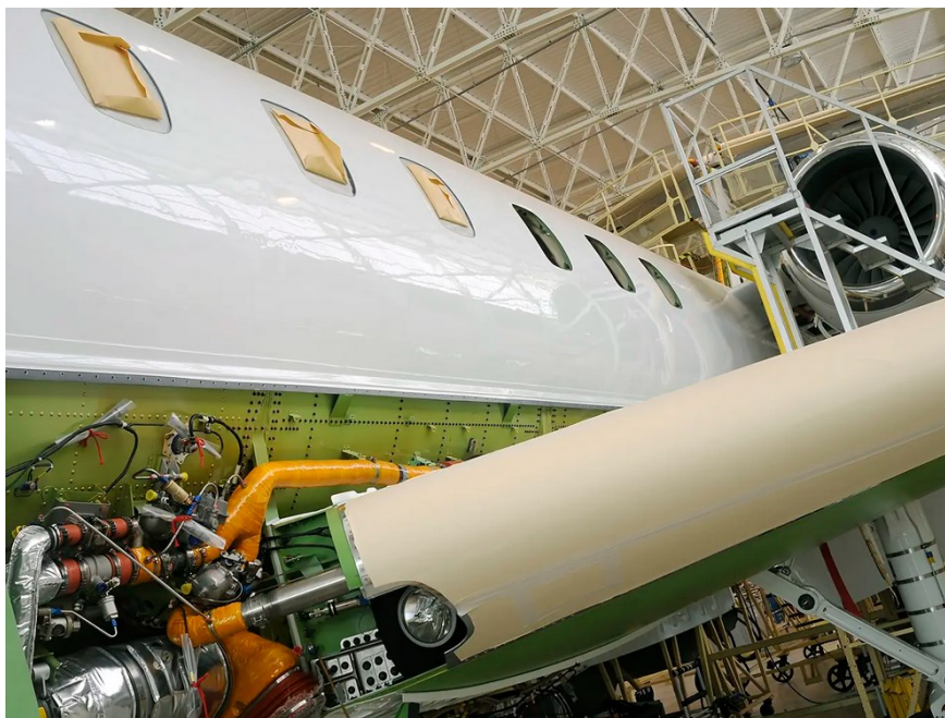
Obrázek 13 – Části trupu dopravního letadla vyrobené technologií RTM [14]
