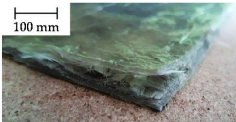
Obrázek 22 – Nedostatečná impregnace vláken na okrajích kompozitu [23]
