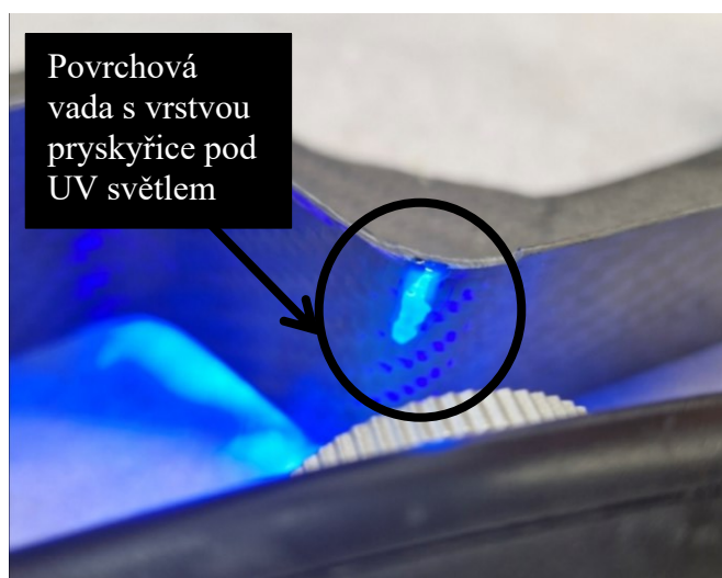
Obrázek 52 – Vytvrzování pryskyřice pomocí UV lampy na vzorku č. 5
