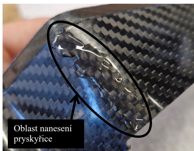
Obrázek 45 – Nanesená druhá vrstva pryskyřice na vzorku č.3
