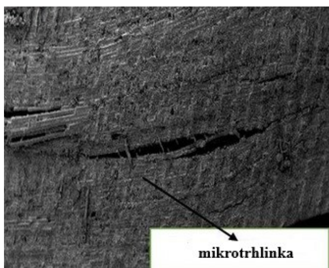
Obrázek 25 – Snímek mikroskopické praskliny pomocí elektronového mikroskopu [24]
