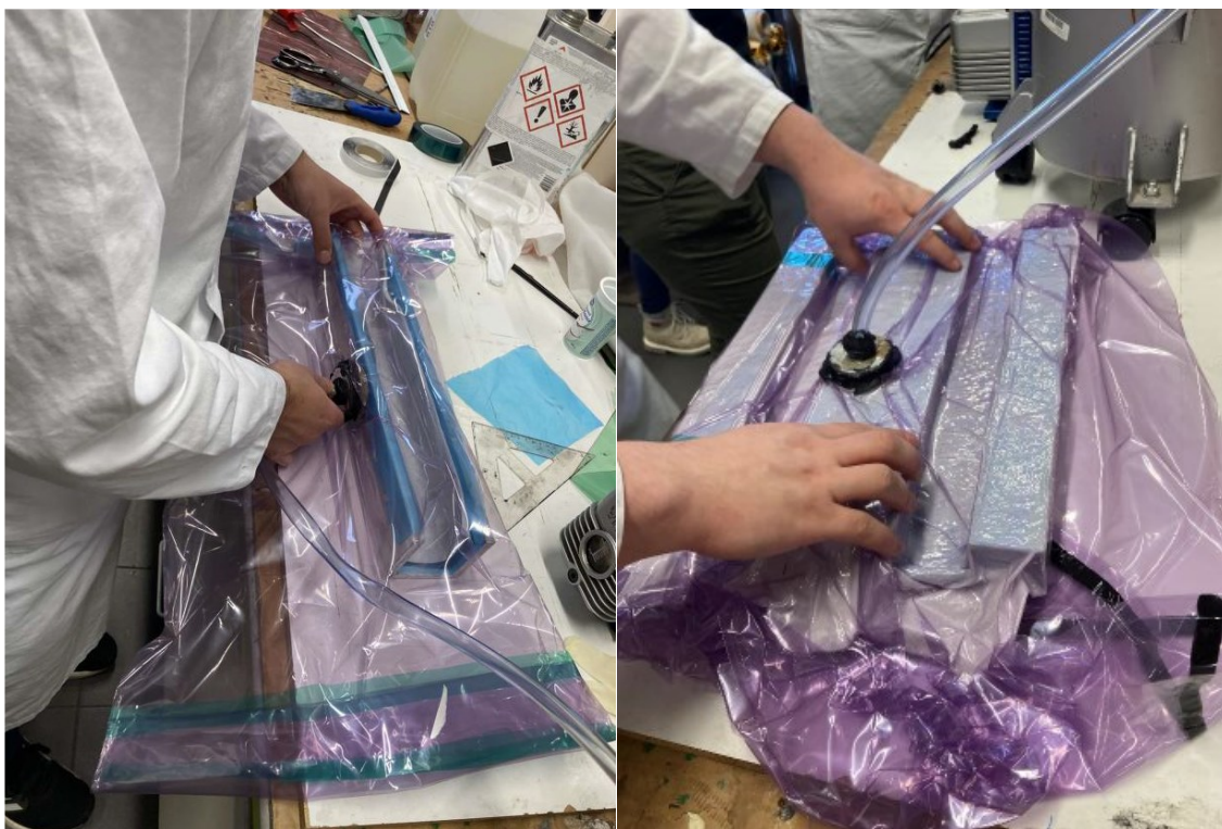
Obrázek 10 – Umístění formy do vakuovacího pytle a následné odsávání vzduchu
