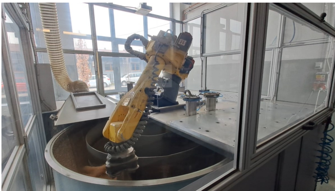
Obrázek 113 Omílání nástroje před povlakem
