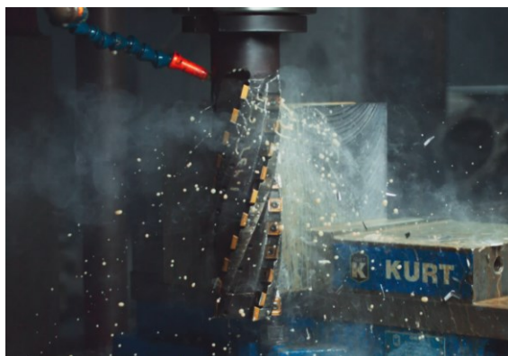
Obrázek 39 Stopková fréza s VBD ve šroubovici
