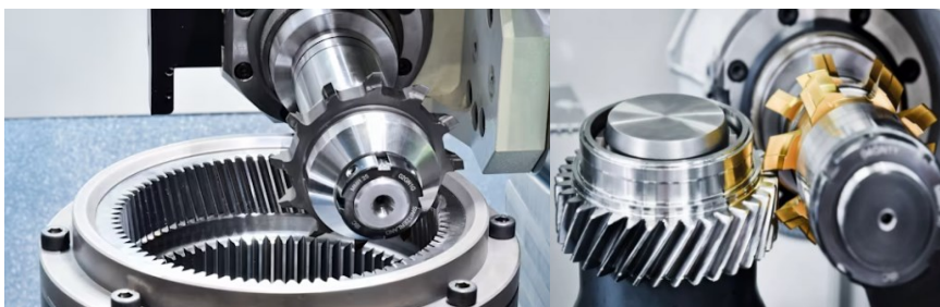
Obrázek 29 Výroba vnitřního a vnějšího ozubení tvarovou nástrčnou frézou
