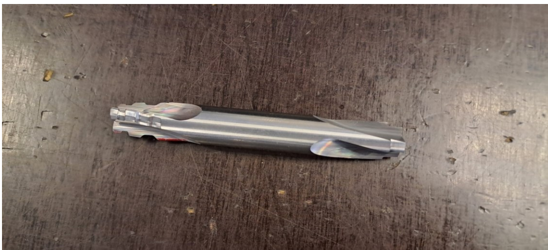
Obrázek 112 Najížděcí kus s hotovou geometrií
