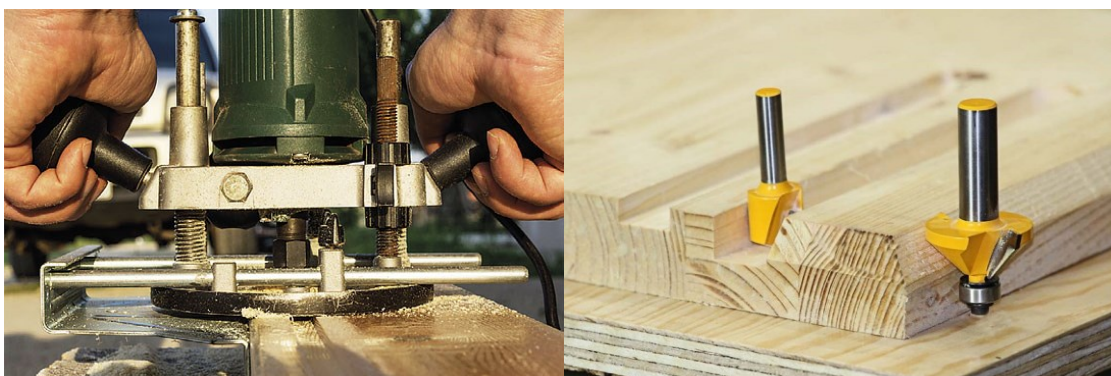
Obrázek 7 Frézování drážky (vlevo), frézy do dřeva
