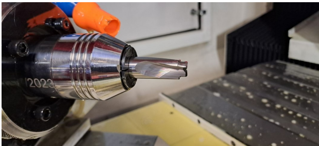
Obrázek 108 Vyšpičkování čela stopkové frézy
