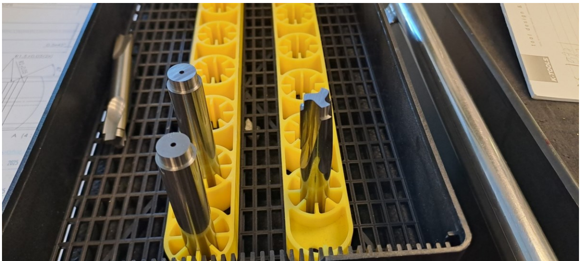
Obrázek 103 Polotovar s hotovou zubovou mezerou
