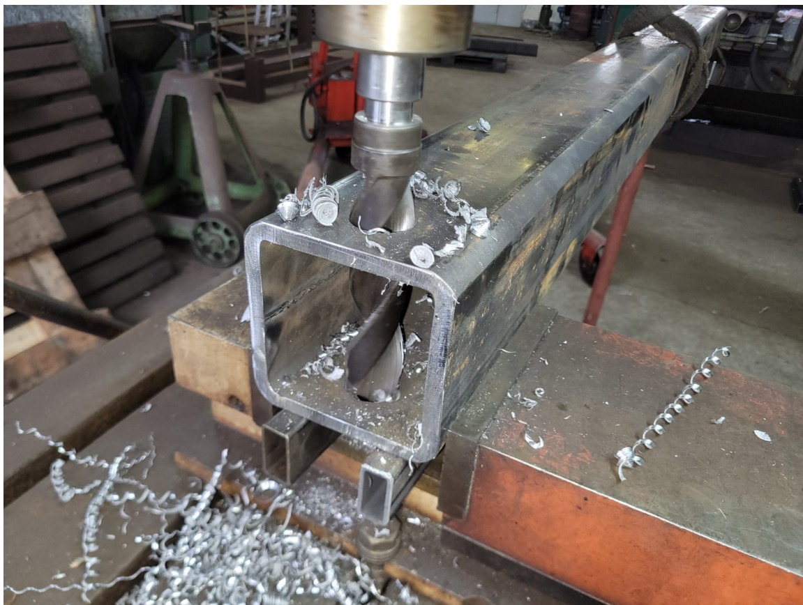
Obrázek 59 Vrtání díry průměru 35 mm do jeklu 120 mm
