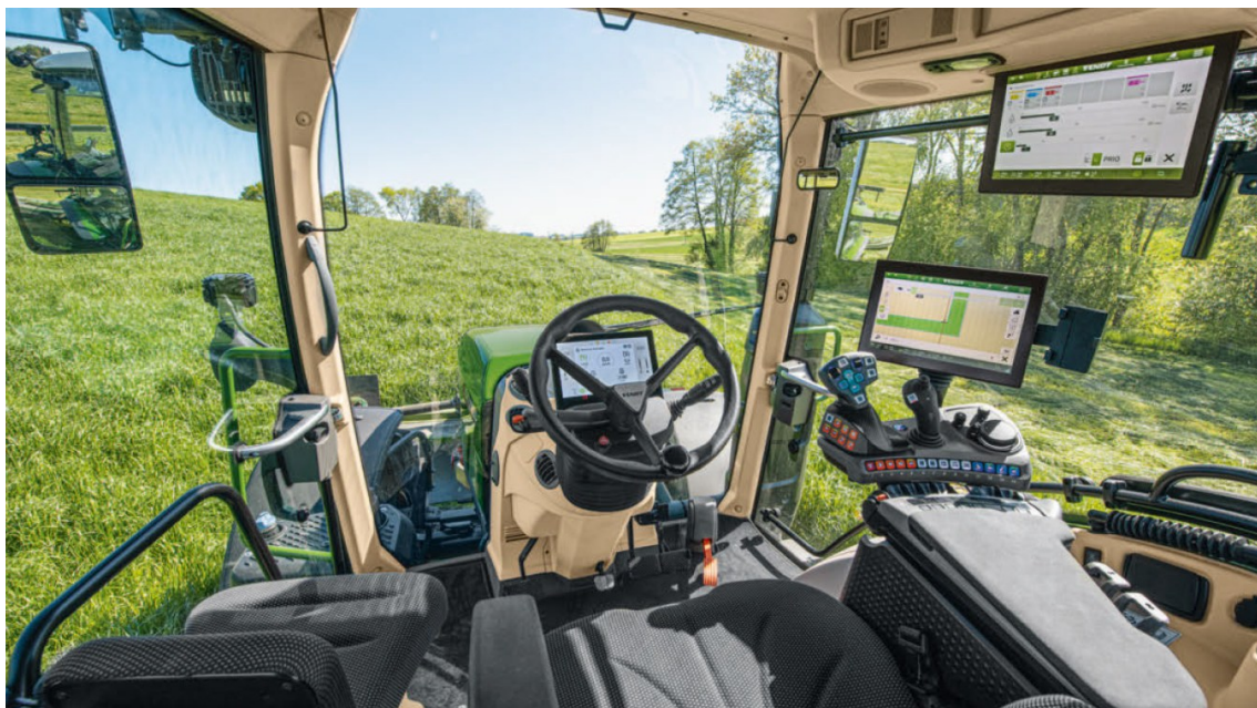
Obrázek 29 Automatický řídicí systém traktoru Fendt
