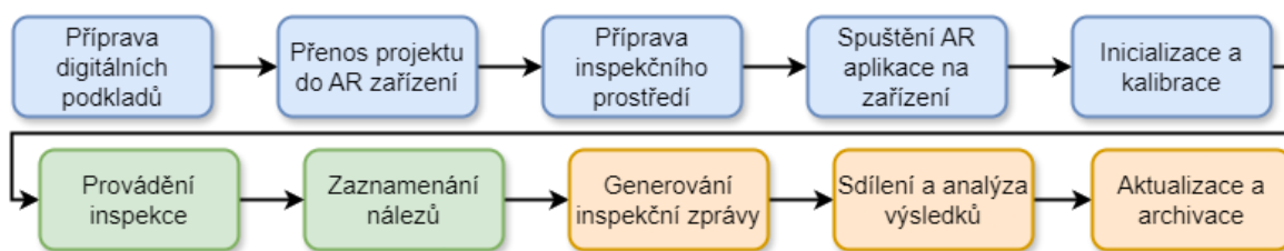
Obrázek 16 Postup inspekčního procesu s využitím AR
