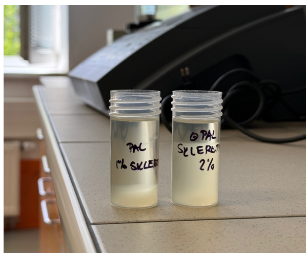
Obrázek 42 - Separace vzorků Sclerotium 1% a 2% po 28 dnech
