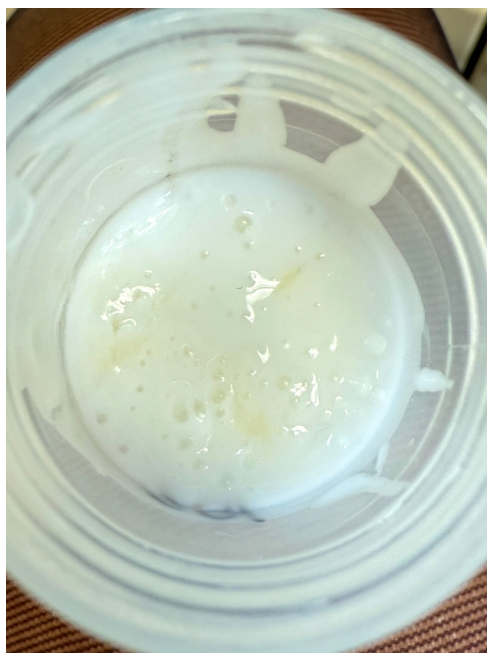
Obrázek 27 - Zbarvení vzorku s přídavkem Natrosolu 2 % do žluta
