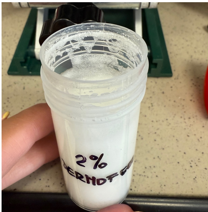
Obrázek 26 - Detail nerozpuštěných částic ve vzorku s Dermofeel zahušťovadlem (stav přetrvává od počátku pozorování)
