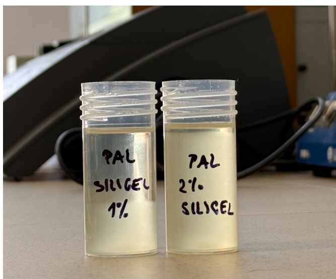
Obrázek 39 - Vzorky Siligel 1 % a 2 % po 28 dnech: u obou koncentrací patrná separace
