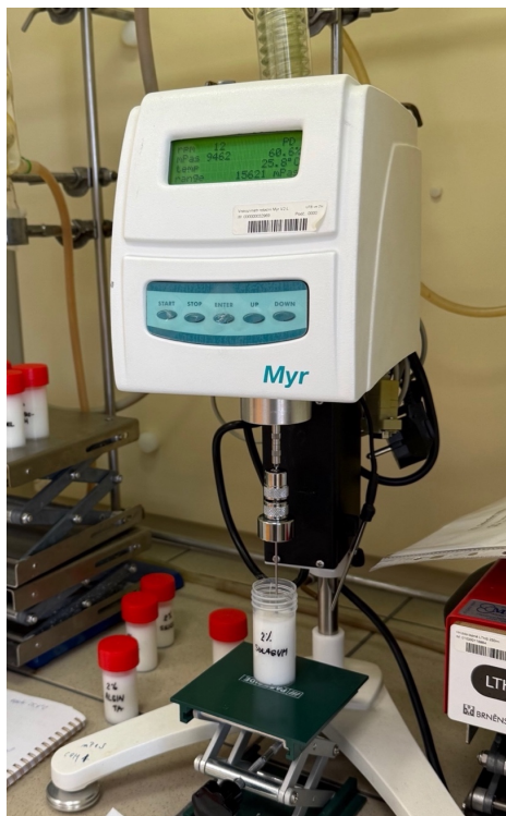
Obrázek 14 - Rotační viskozimetr MYR V2-L s adaptéry PD/PE při měření vzorku emulze
