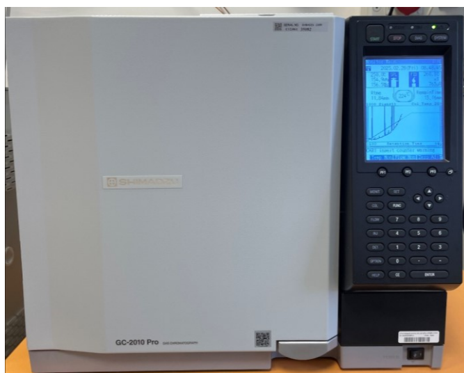
Obrázek 5: Plynový chromatograf Shimadzu GC-2010 Pro
