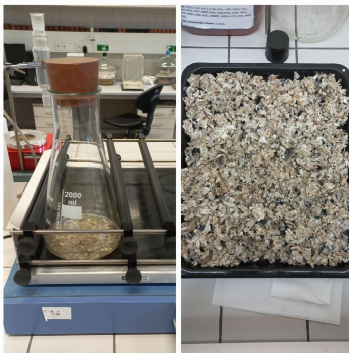
Obrázek 13 Odtučnění suroviny. Vlevo proces odtučňování na třepacím zařízení. Vpravo vysušená odtučněná surovina.
