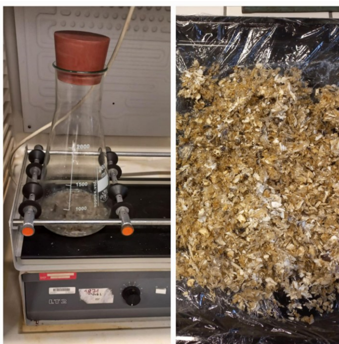
Obrázek 14 Demineralizace suroviny. Vlevo proces demineralizace. Vpravo vysušená demineralizovaná surovina.
