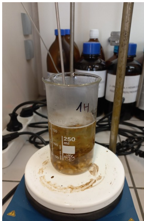
Obrázek 6 Zahřívání suroviny v 0,1 mol/l roztoku NaOH
