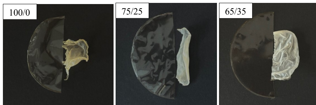
Obrázek 18 Vzorky filmů v různých poměrech alginát sodný/ Aloe vera : vlevo) nezesíťovaný; vpravo) zesíťovaný 1% BaCl 2
