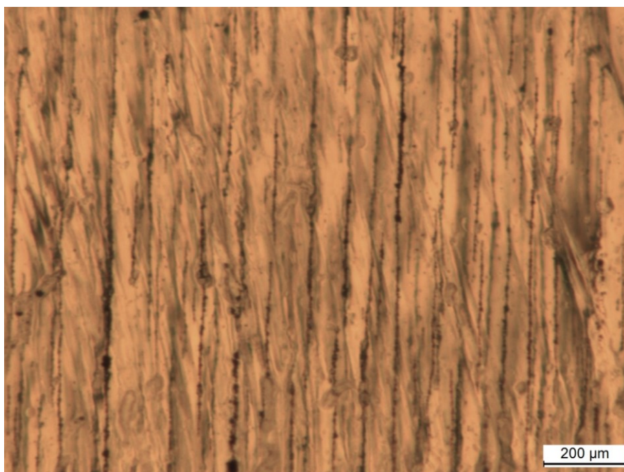
Obrázek 32 Detail jednotlivých „jehlic“ částic železa v želatině vytvořených vlivem magnetického pole.
