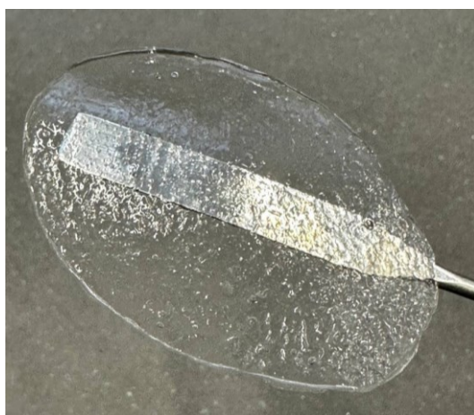
Obrázek 10 Alginát 2 (100–200 kDa) po zasítování
