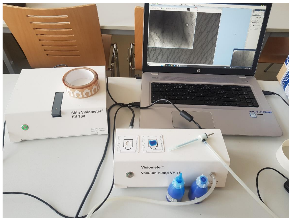
Obrázek 9 Visiometer® SV 700 s vakuovou pumpou a pomůckami pro snímání silikonových replik
