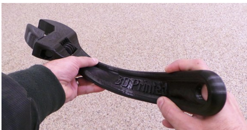
Obrázek 4 Klíč vytištěný z TPU [14]
