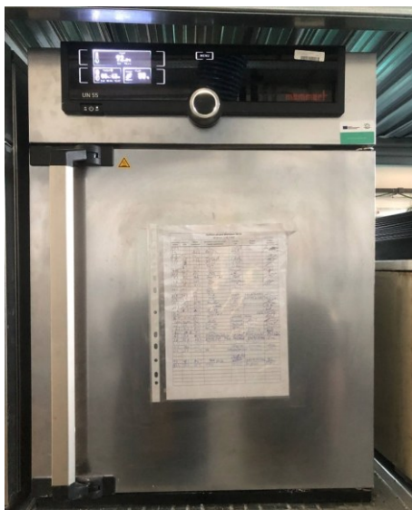
Obrázek 15 Sušárna MEMMERT UN55 53I
