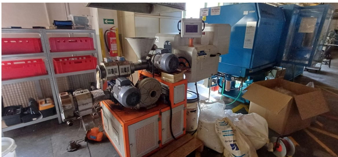
Obrázek 12 Planetový šnekový extruder Platex
