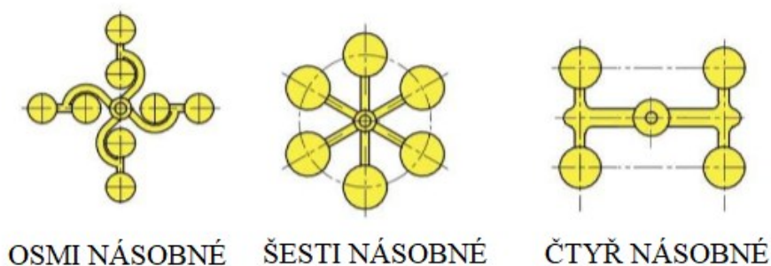
Obrázek 14 Příklad rozložení dutin při vyšší násobnosti formy [22]
