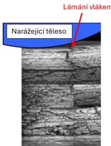
Obrázek 109 Lámání uhlíkových vláken vyztužujících epoxidovou pryskyřici [20]
