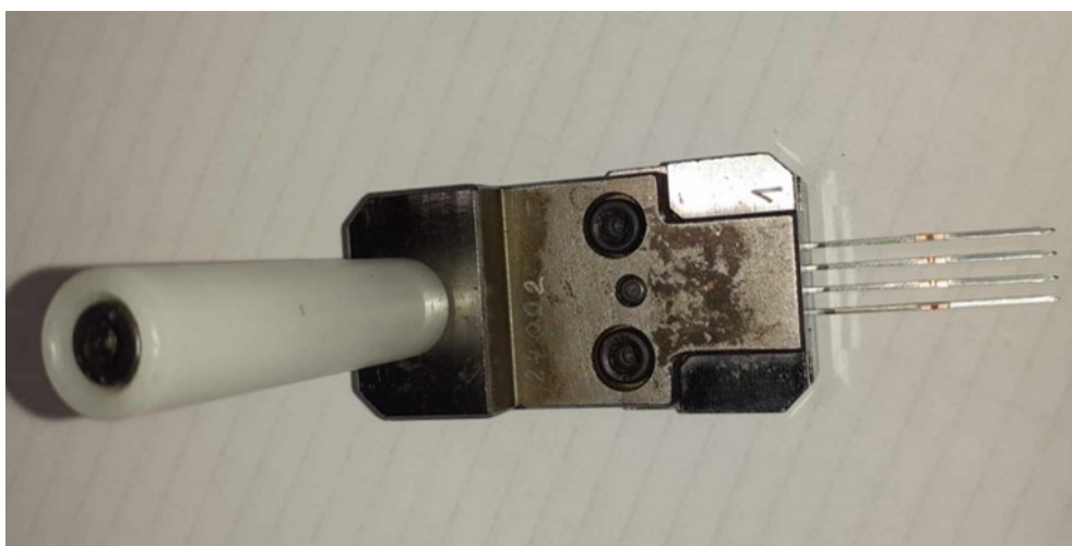
Obrázek 21 Správné vložení zálisků
