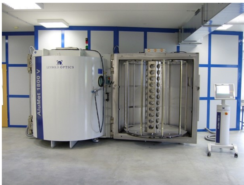
Obrázek 16 Komora vakuového pokovení
