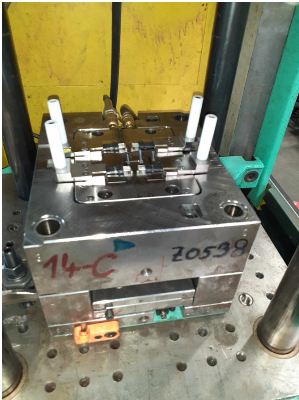
Obrázek 22 Vložení přípravků se zálisky do formy
