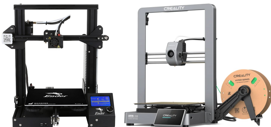
Obrázek 6 Porovnání 3D tiskáren Ender 3 – první a třetí generace [19, 20] (převzato a upraveno)
