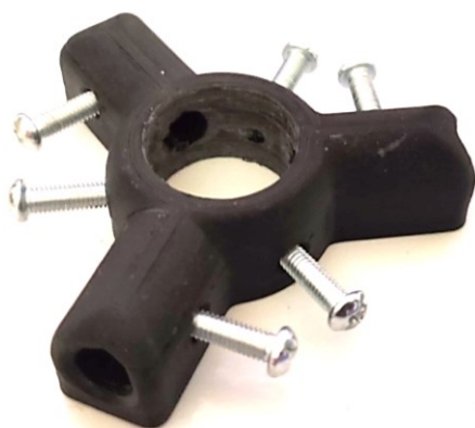
Obrázek 37 Hřídelová spojka lopatek vztlakové VAWT (vlevo); Hřídelová spojka lopatek odporové VAWT (vpravo)
