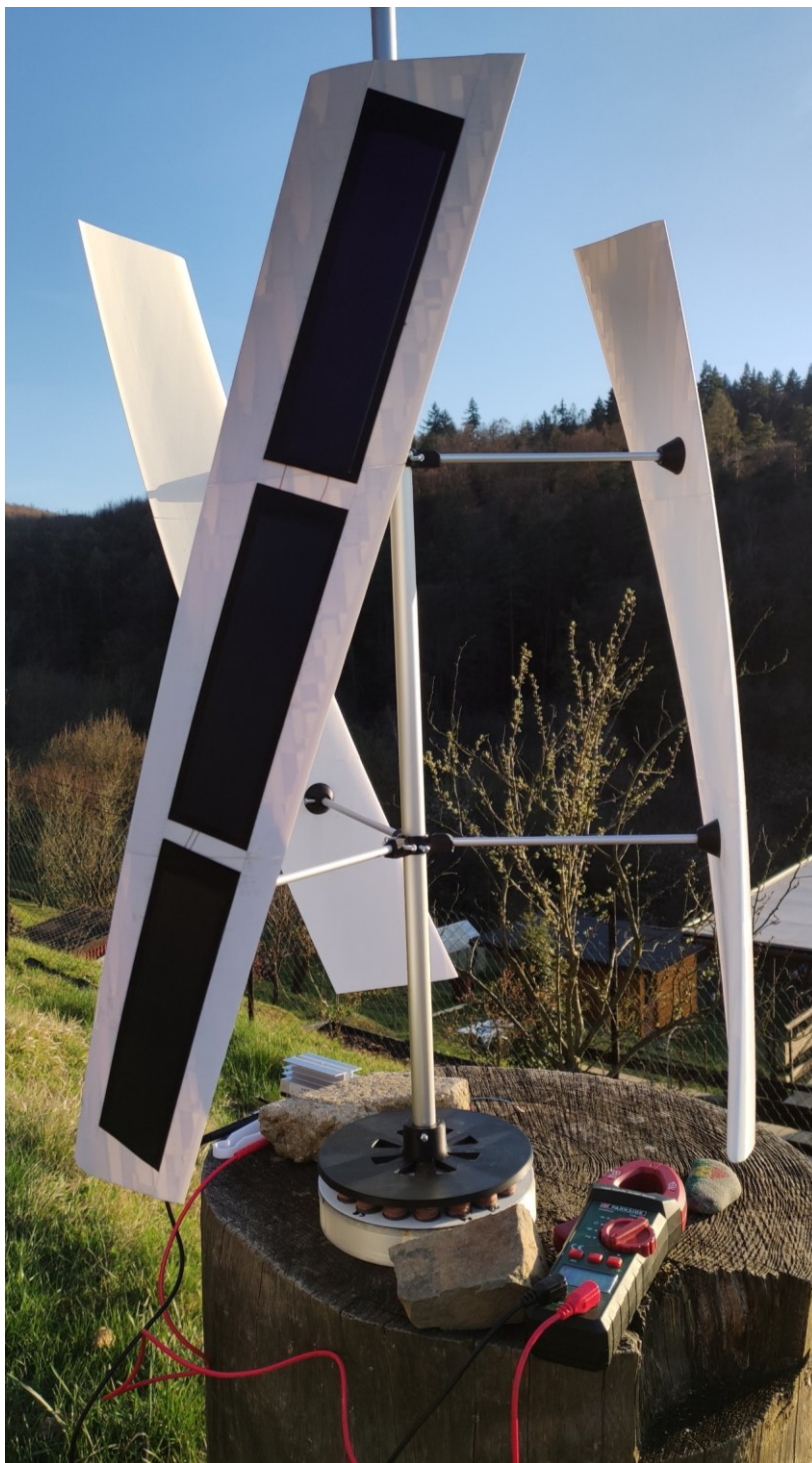
Obrázek 48 Měření napětí na hybridní vztlakové VAWT
