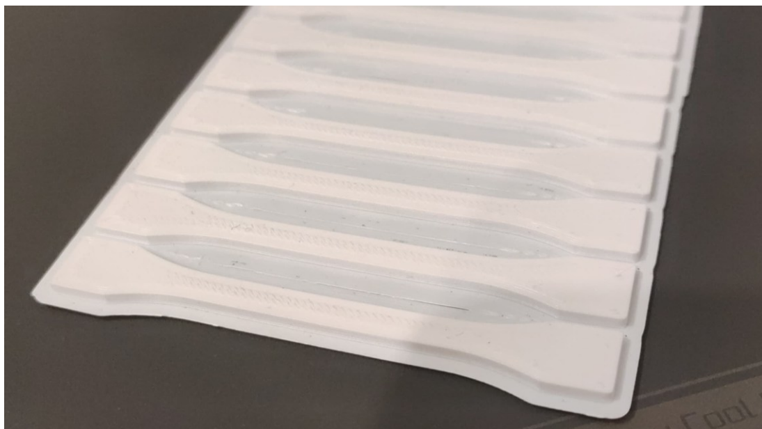
Obrázek 52 Ukázka testovacích tělísek z ASA tisknutých s límcem
