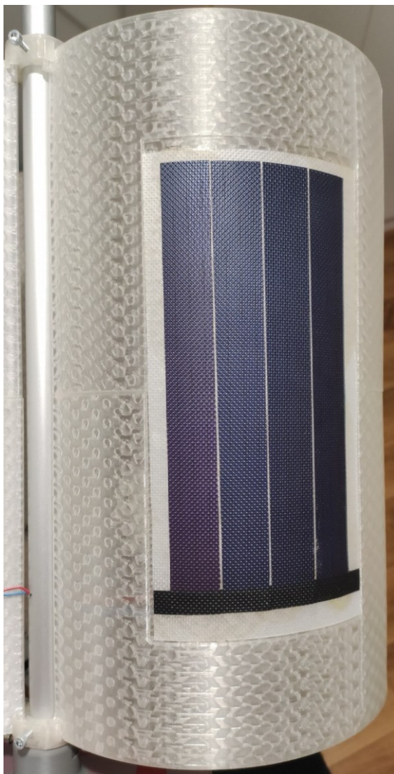
Obrázek 36 Lopatka odporové VAWT s flexibilním FV panelem
