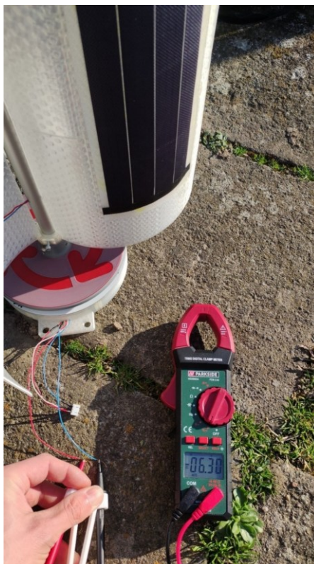
Obrázek 42 Měření napětí z fotovoltaických panelů na hybridní odporové VAWT
