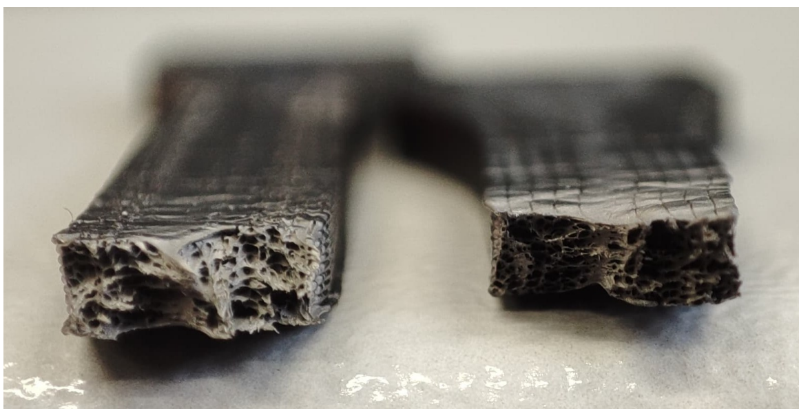
Obrázek 56 Detailní pohled na přetržené testovací tělísko z PET-G HF značky Bambulab
