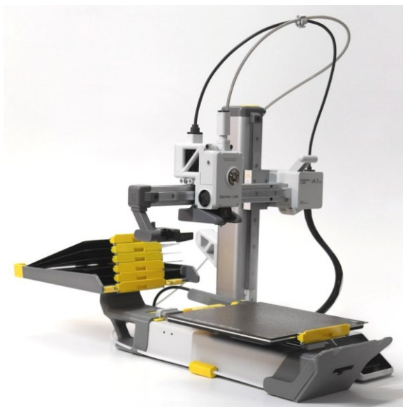
Obrázek 9 Vizualizace možnosti automatizace 3D tiskárny typu bedslinger [23]
