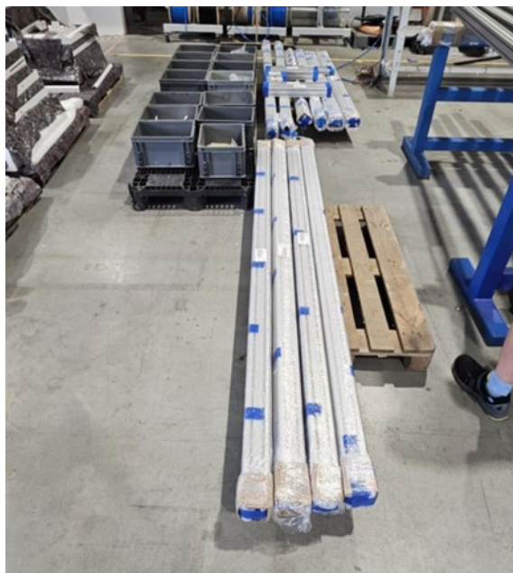
Obrázek 21 Příklad špatného uskladnění vstupních komponentů při pilotní montáži
