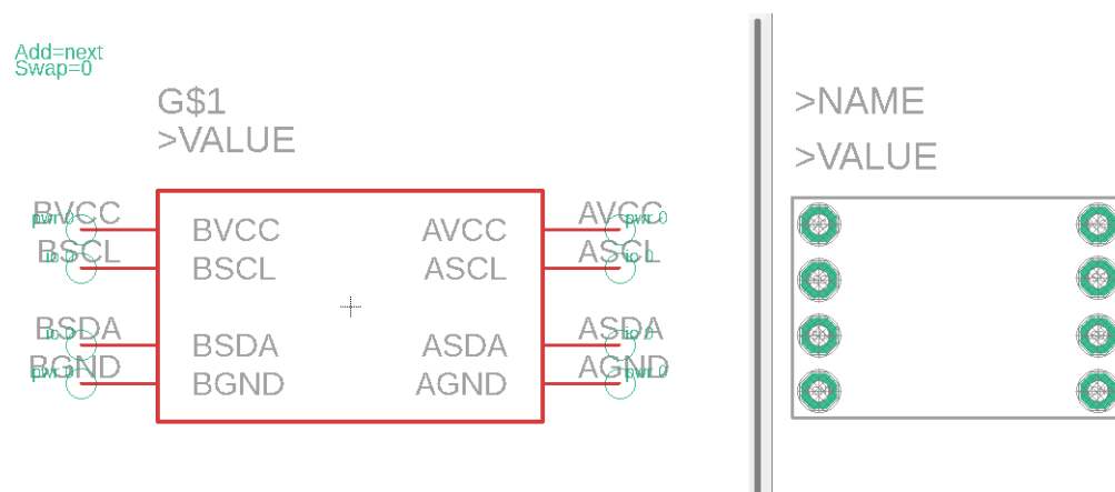
Obrázek 8 Knihovna převodníku napětí (nalevo schéma v obvodu, napravo schéma v rozvržení desky plošných spojů)
