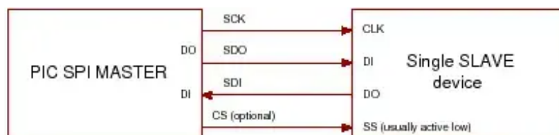
Figure 2.4 Schéma zapojení jednoho zařízení na sběrnici SPI . V tomto případě je signál CS volitelný a není potřeba.
